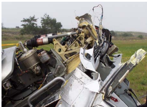
圖 1.12-6 液壓系模組損壞圖
