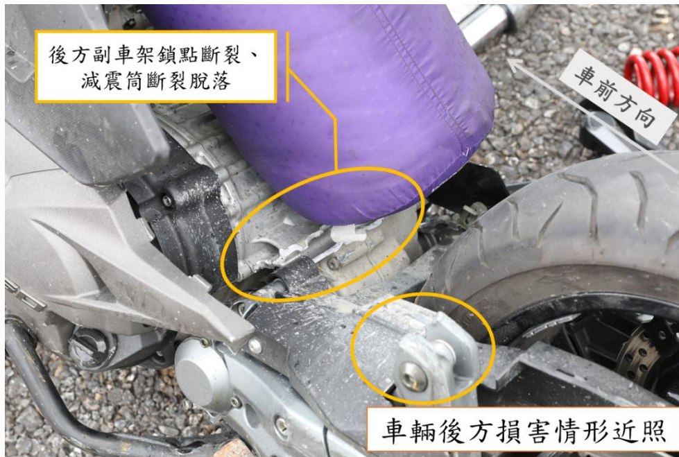
圖 1.4-9 F 車損害情形（車輛後方）
