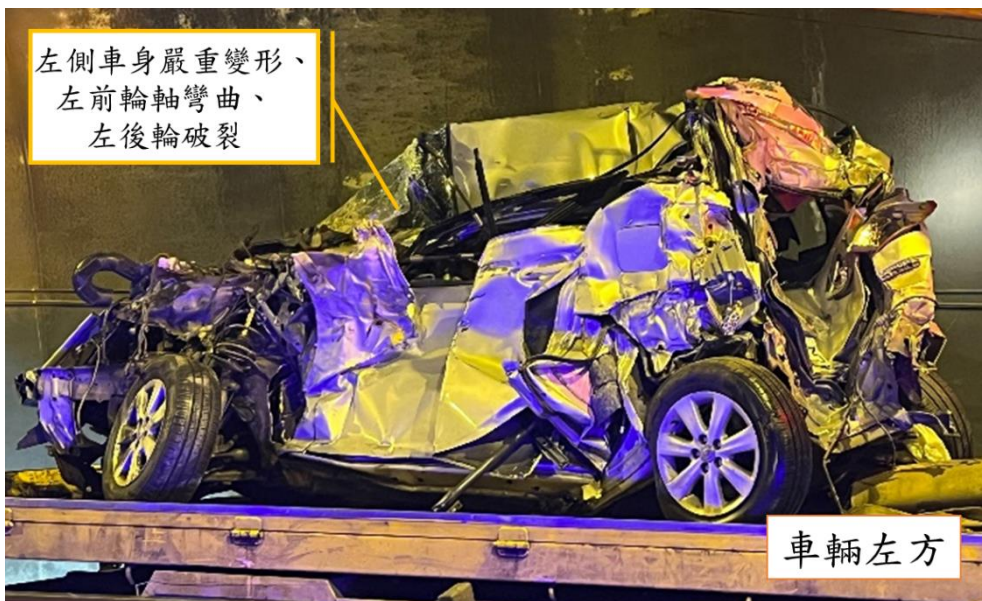
圖 1.4-3 B 車損害情形（車輛左方）
