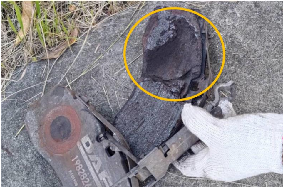
圖 1.3-2 事故曳引車右後輪外側來令片燒燬情形
