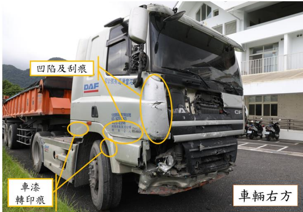
圖 1.3-4 事故曳引車損害情形（車輛右方）
