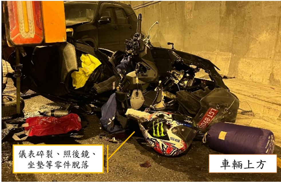
圖 1.4-7 F 車損害情形（車輛上方）
