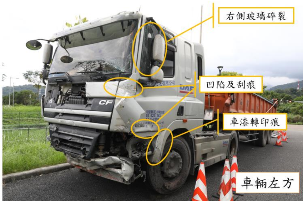
圖 1.3-3 事故曳引車損害情形（車輛左方）
