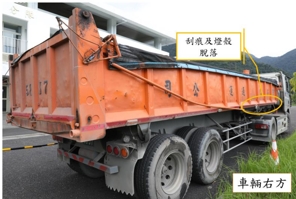
圖 1.3-8 事故半拖車損害情形（車輛右方）
