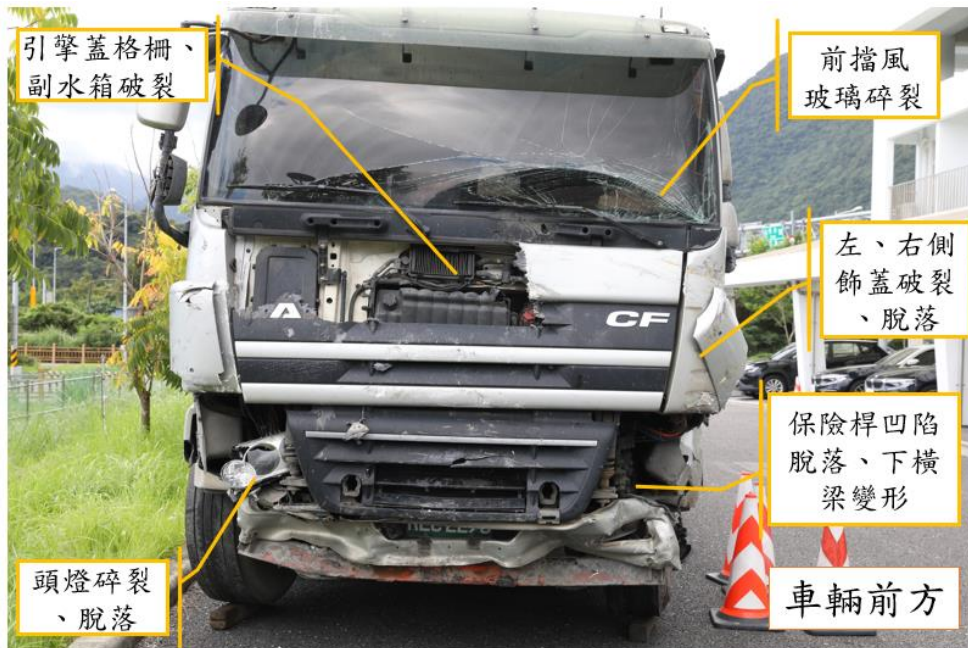
圖 1.3-5 事故曳引車損害情形（車輛前方）
