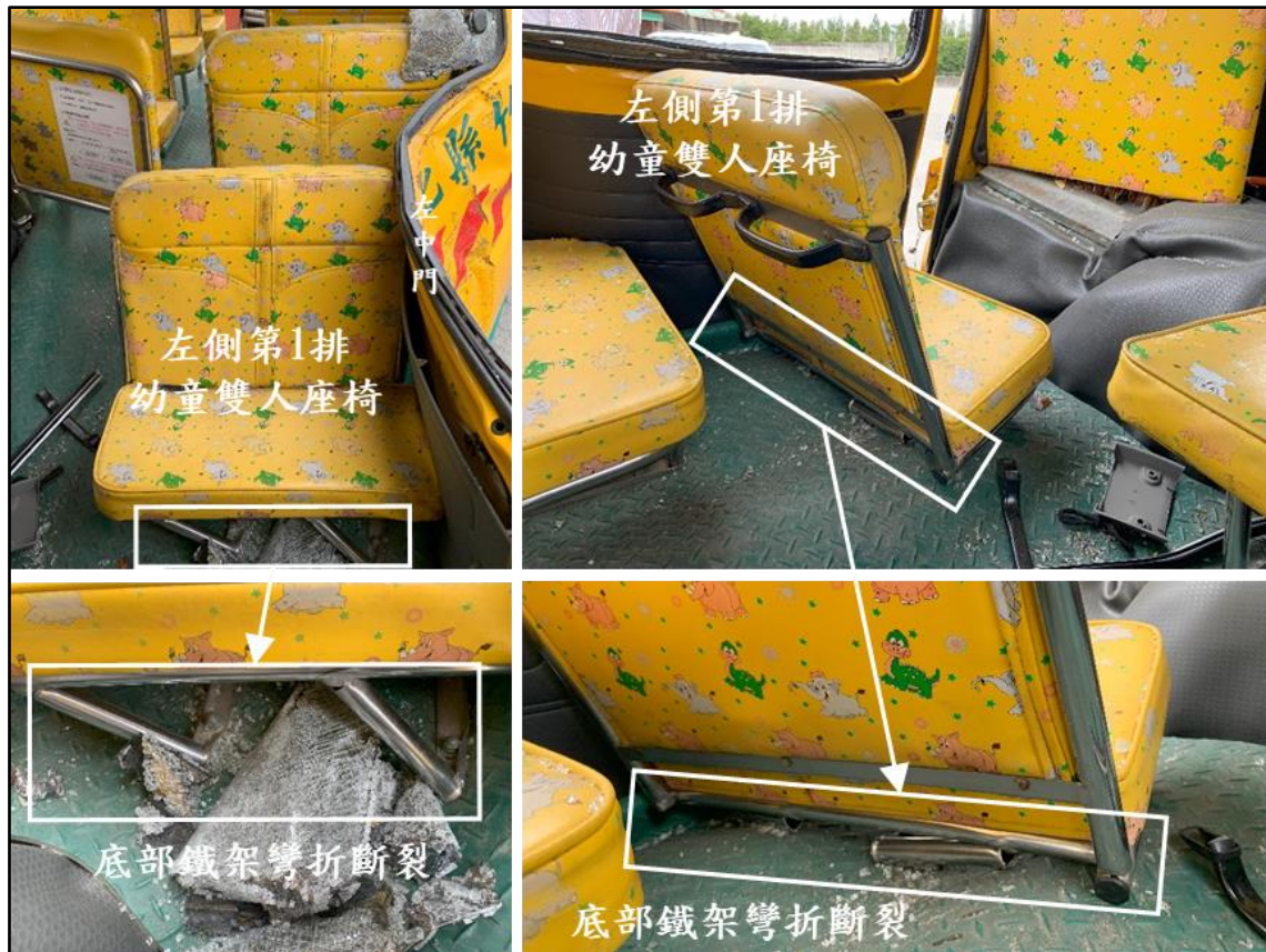
圖 1.3-8 左側第 1 排幼童雙人座椅受損情形
