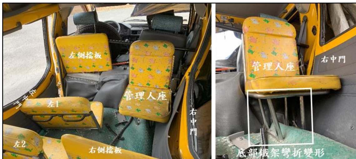
圖 1.3-7 管理人座椅受損情形
