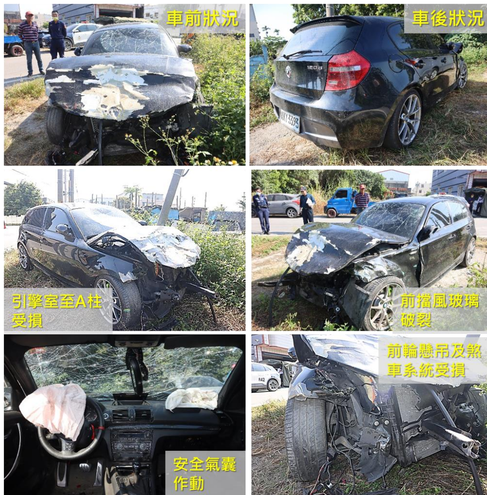
圖 1.4-1 事故 B 車損害情形
