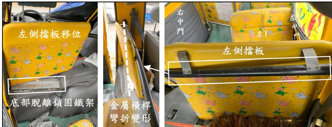
圖 1.3-6 左側擋板受損情形
