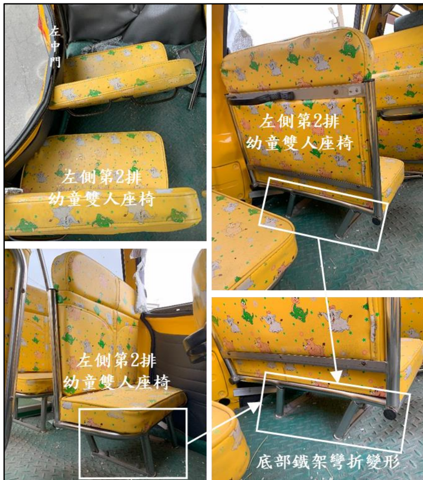
圖 1.3-9 左側第 2 排幼童雙人座椅受損情形
