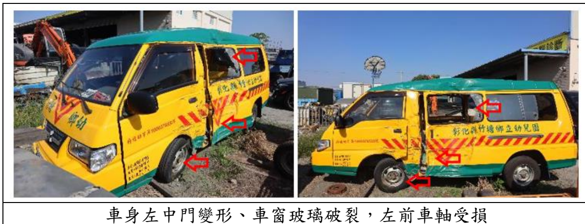
圖 1.3-11 事故 A 車損害情形
