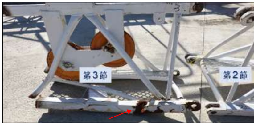
圖 1.3-12 第 3 節左下弦桿之撞擊痕跡
