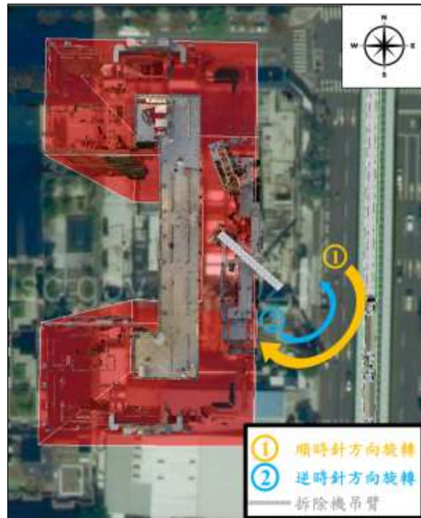
圖 1.1-10 拆除機作業旋轉方向示意圖
