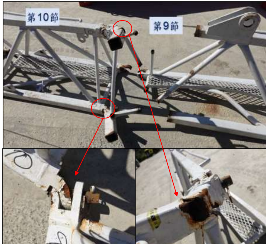
圖 1.3-14 第 9 節上弦桿斷裂（下圖右），與第 10 節接合處變形（下圖左）
