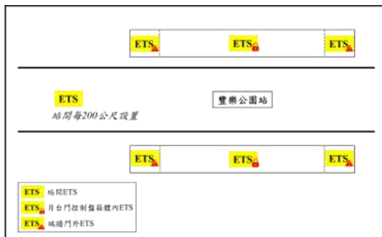
圖 1.9-2 緊急斷電箱（ETS）位置圖
