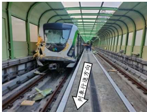
圖 1.1-2 列車車頭撞及塔式起重機桁架後毀損
