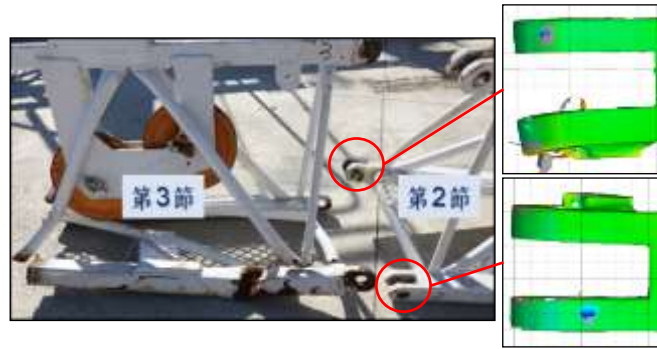
圖 1.3-11 第 2 節與第 3 節接合處變形（圖右）
