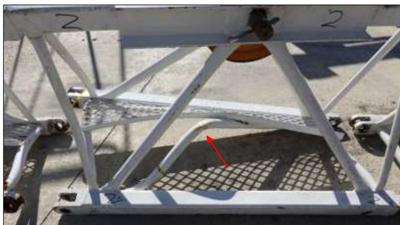
圖 1.3-10 第 2 節水平斜桿突起變形
