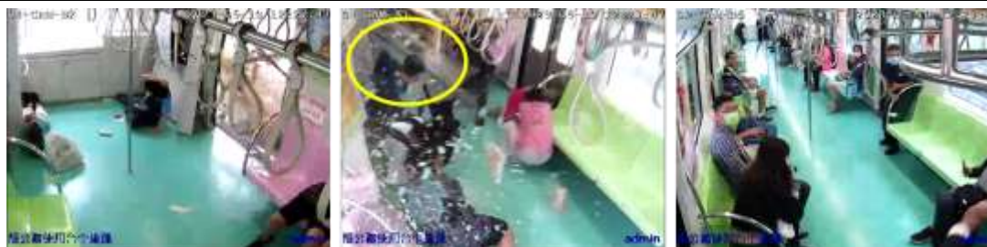
1227:47 事故列車撞及桁架後 1 秒，桁架組件侵入 04 車廂
