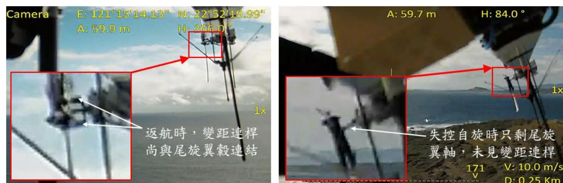
圖 7 事故機飛行中變距連桿正常（左）與異常（右）之影像
