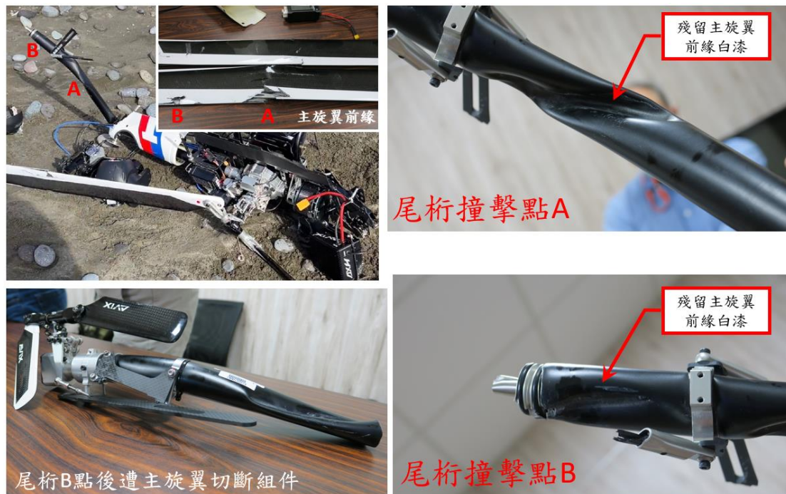
圖 6 主旋翼片撞擊尾桁示意圖
