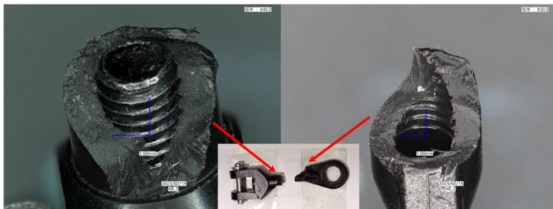
圖 17 變距連桿損傷情形
