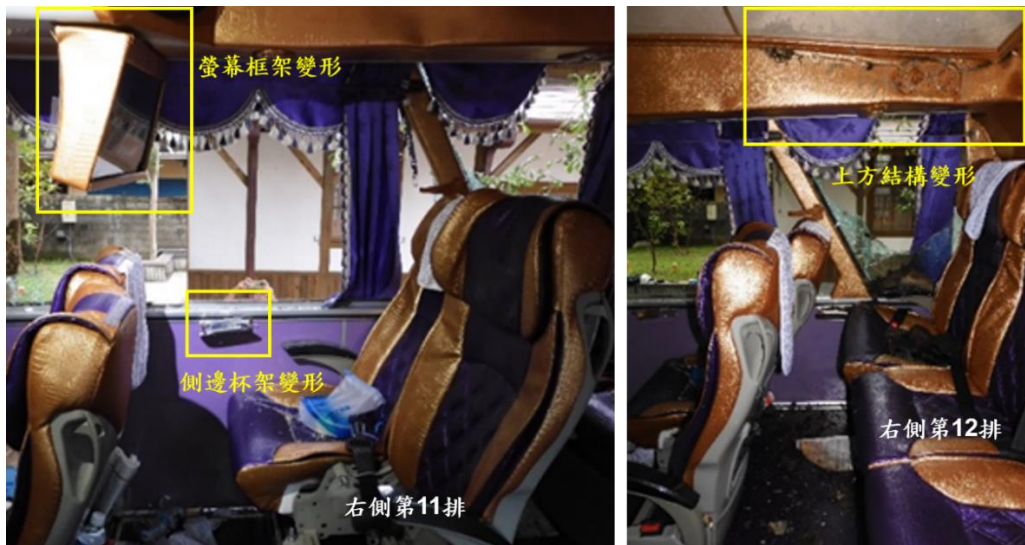
圖 1.3-6 事故車輛右側第 11、12 排損壞情形
