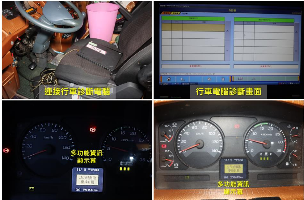
圖 3 行車電腦檢測情形
