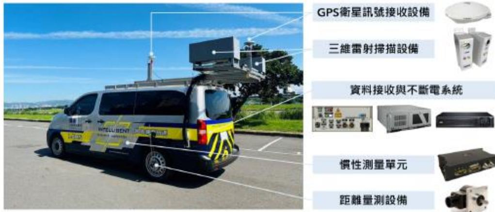
圖 2.1-1 LCMS 鋪面雷射檢測系統
