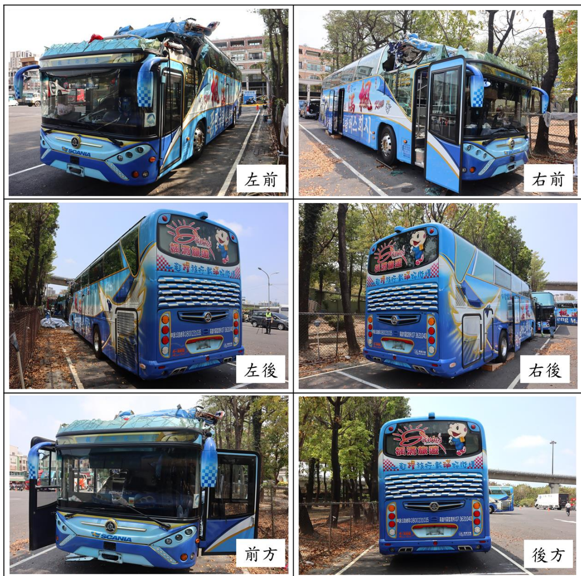
圖 1.3-2 事故車輛損害情形
