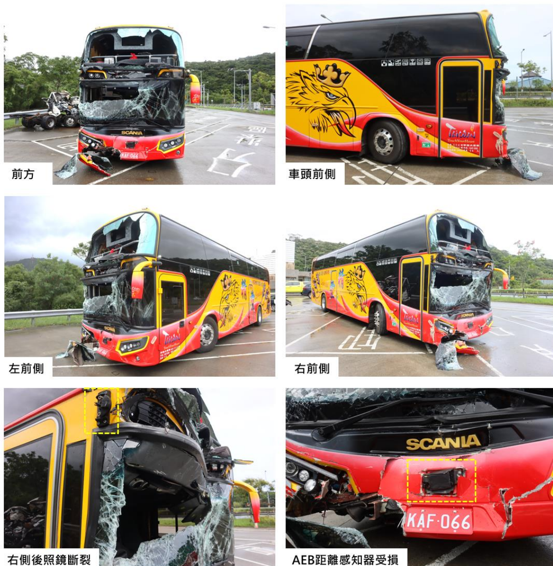
圖 1.3-2 事故車輛損害情形
