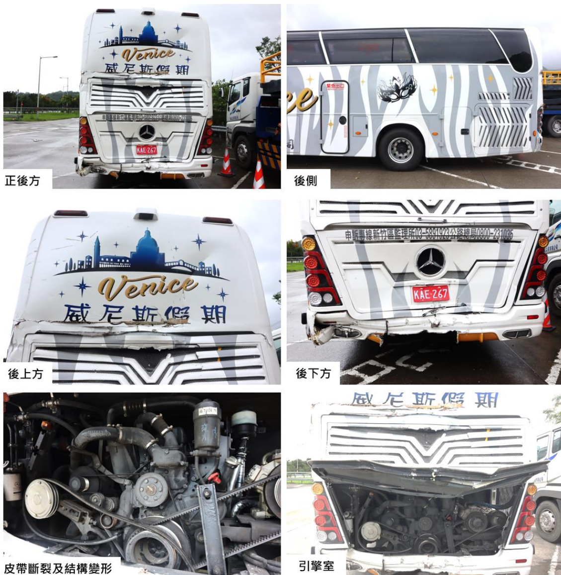
圖 1.4-1 前方遊覽車損害情形
