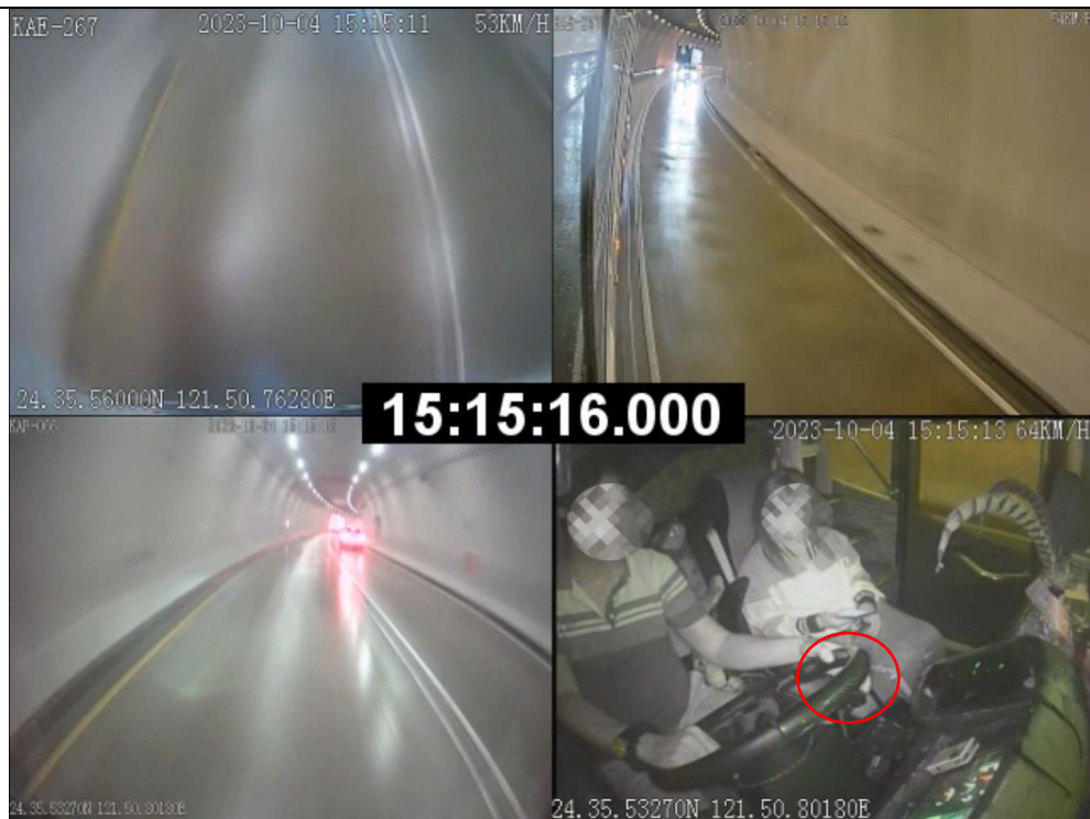
約 15:15:16.0 時事故駕駛員撥下油壓減速器撥桿
