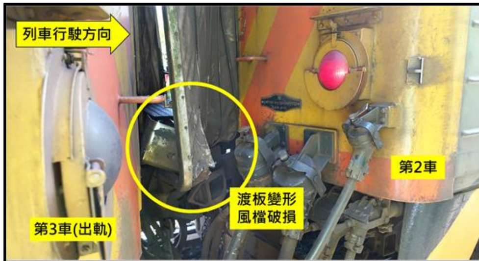
圖 1.3-2 第 2 車與第 3 車間渡板變形、風檔破損
