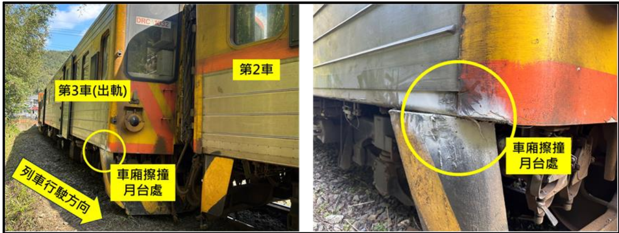
圖 1.3-1 第 3 車前端右側主排障器及部分車身擦傷
