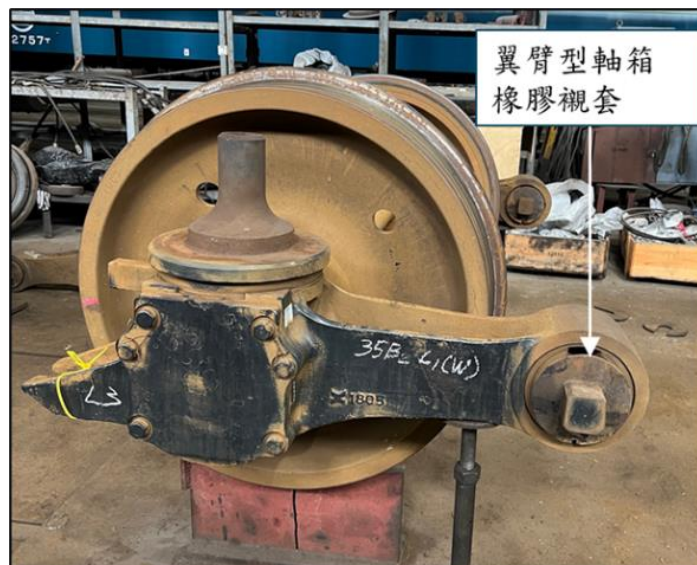
圖 1.11-6 翼臂型軸箱橡膠襯套
