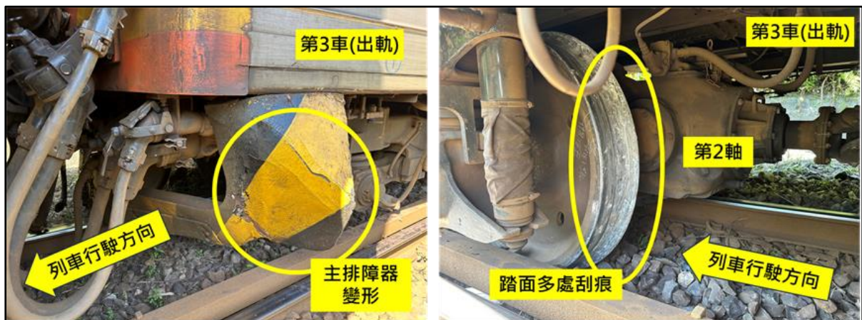
圖 1.3-3 第 3 車前端左側主排障器變形、車輪踏面多處刮痕
