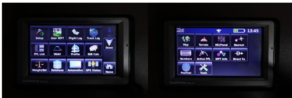
圖 1.11.3-1 機載 GPS 接收機開機畫面
