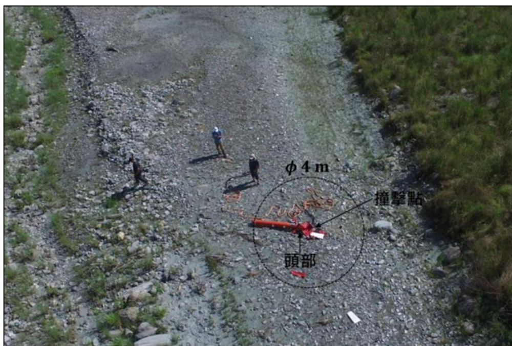
圖 1.17.2-1 探測載具意外脫落之現場照片 (摘自德安航空調查報告)
