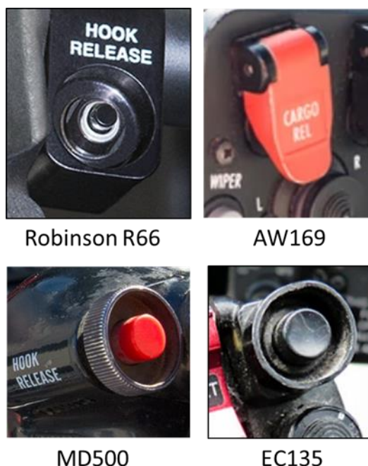
圖 2.3-1 不同機型之貨物吊鉤釋放電門
