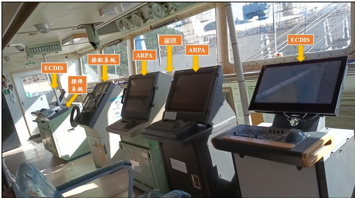
圖 1.7-1 源順輪駕駛臺主要航儀配置圖
