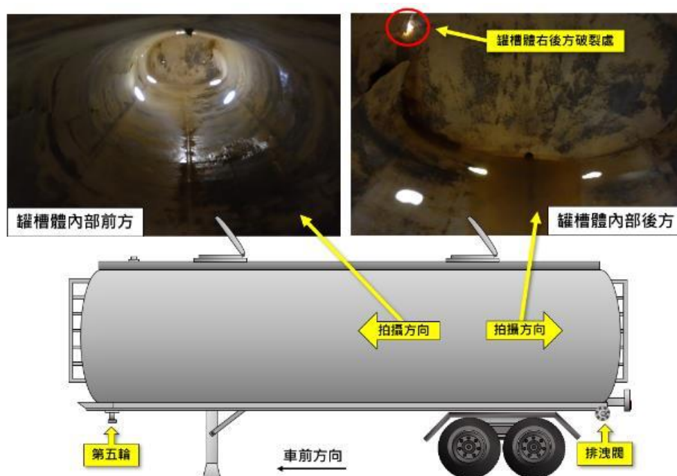
圖 1.3-4 事故車輛罐槽體示意圖及內部拍攝照片
