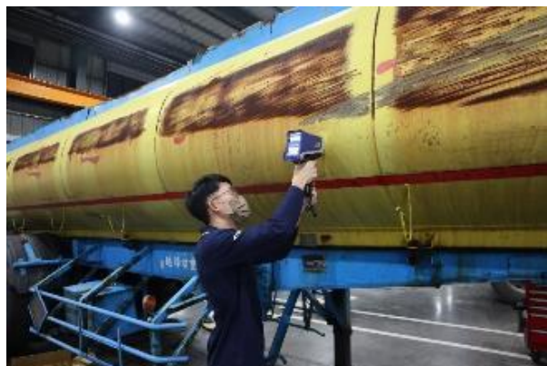
圖 1.3-3 罐槽體厚度及材質量測情形
