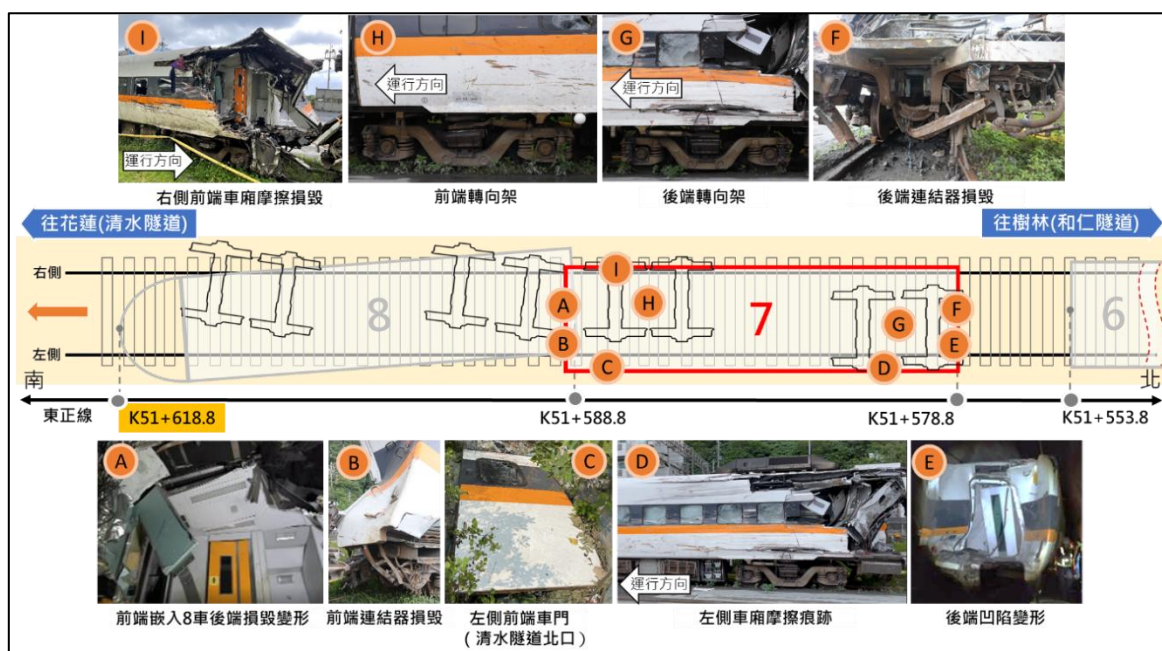
圖 1.3-2 第 7 車損害情形
