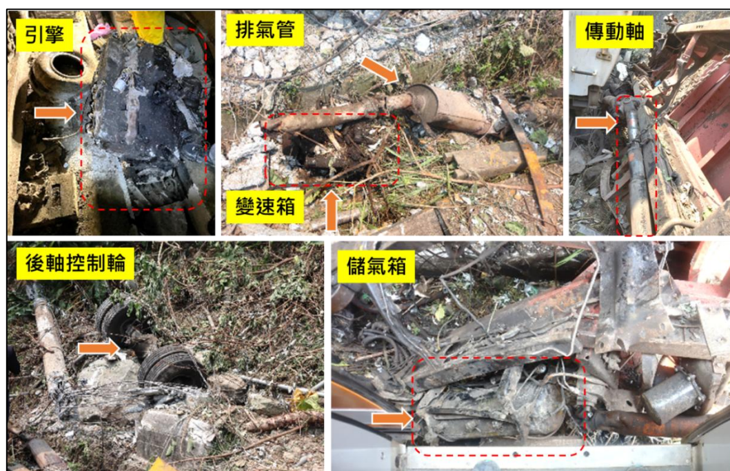
圖 1.3-14 大貨車零組件受損情形
