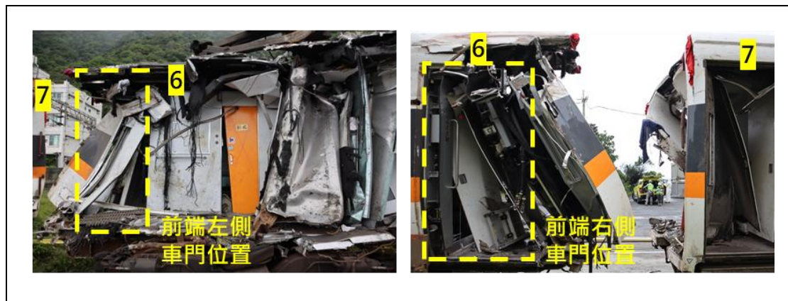
圖 1.13-11 第 6 車前端左、右側車門及玄關通道
