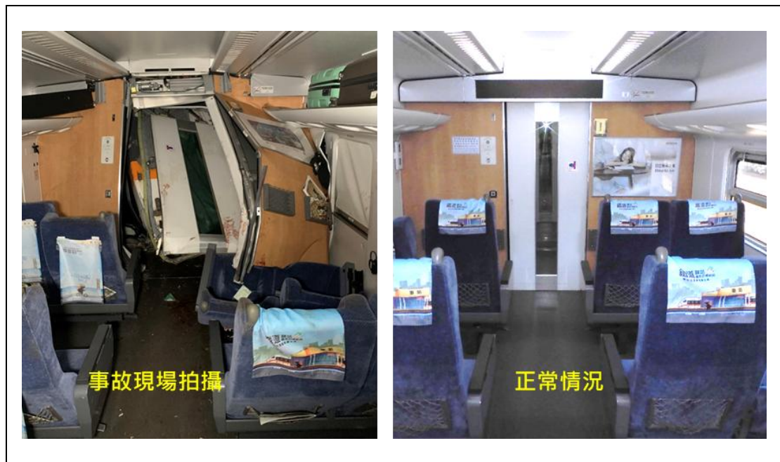
圖 1.13-3 第 4 車前端受損情形
