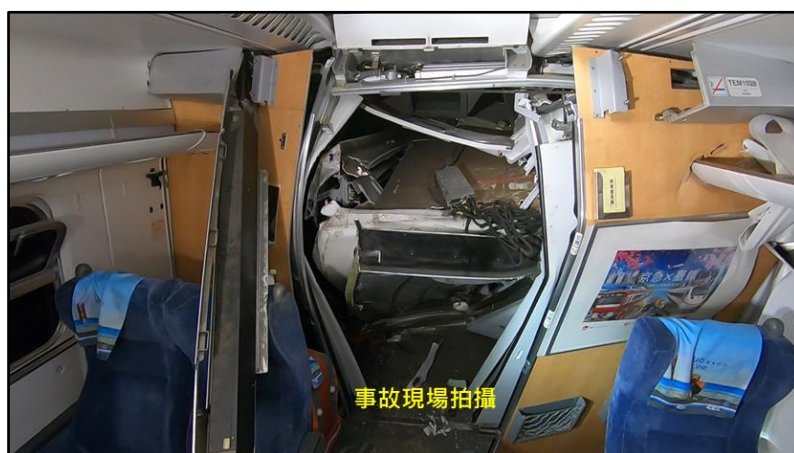
圖 1.13-8 第 5 車後端受損情形
