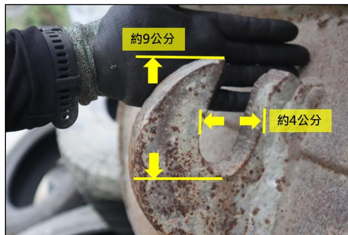
圖 1.8-4 挖斗裝置上之掛勾外觀照片
