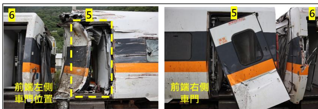
圖 1.13-6 第 5 車前端左、右側車門及玄關通道
