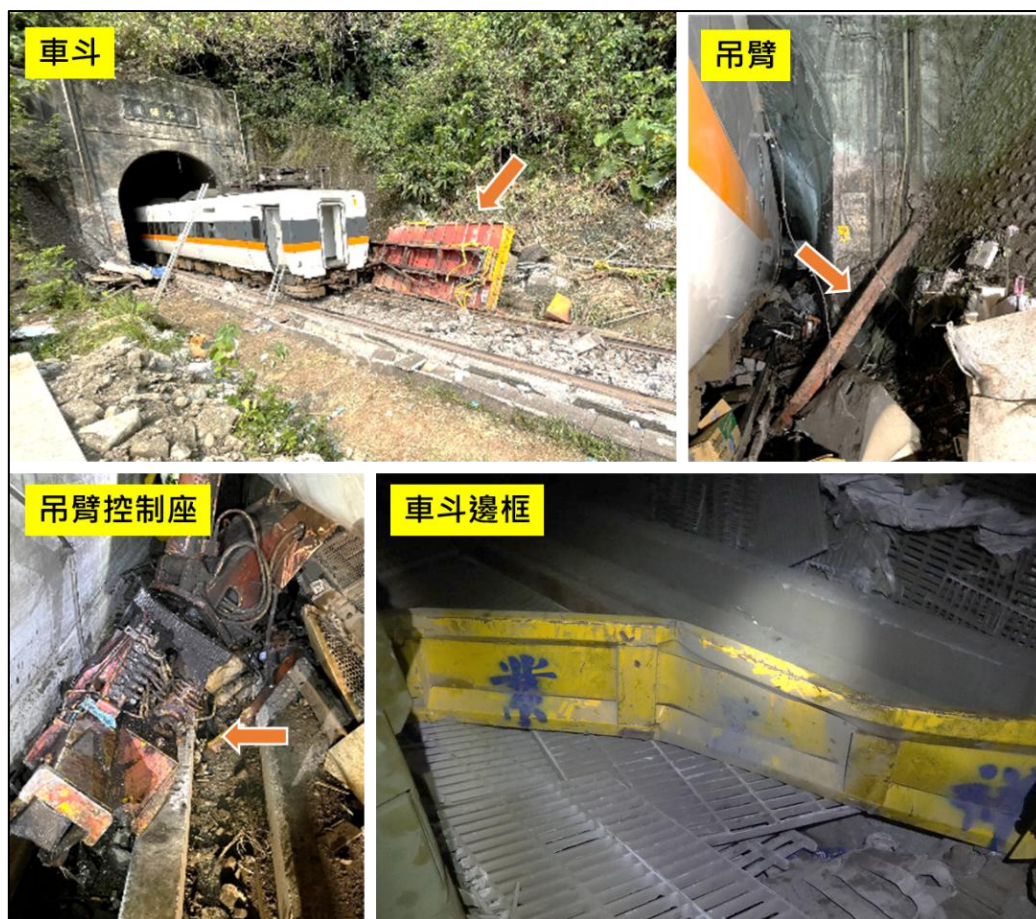
圖 1.3-13 大貨車車身受損情形
