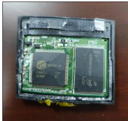
圖 1.10-6 開啟記憶卡外蓋後之內部照片
