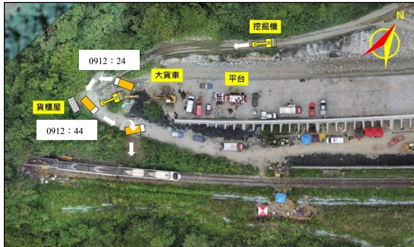
圖 1.1-3 大貨車移動及挖掘機停放位置說明
