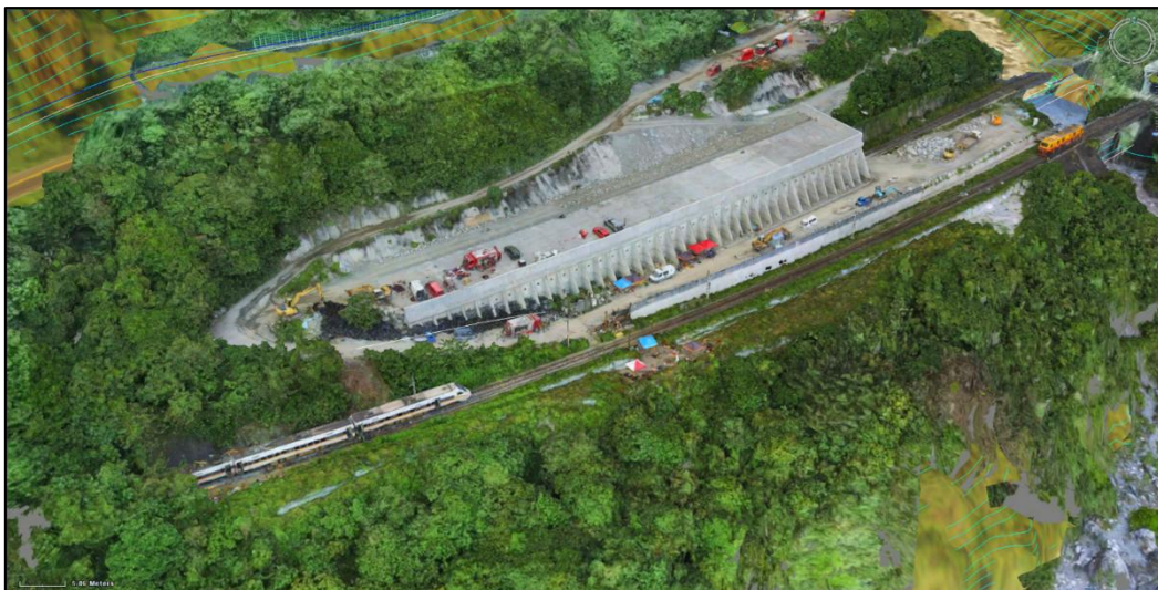
圖 1.11-4 無人機空拍拼接三維點雲與背景圖資套疊
