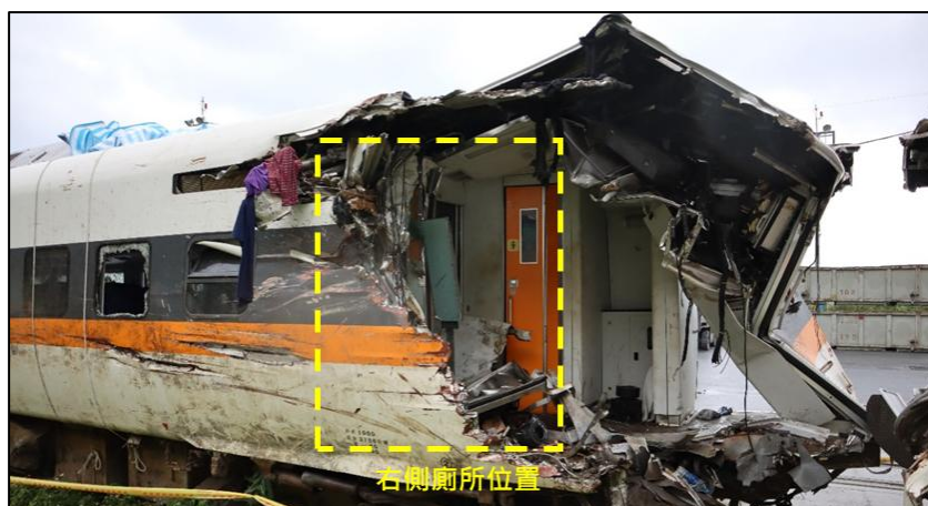
圖 1.13-17 第 7 車女廁受損情形
