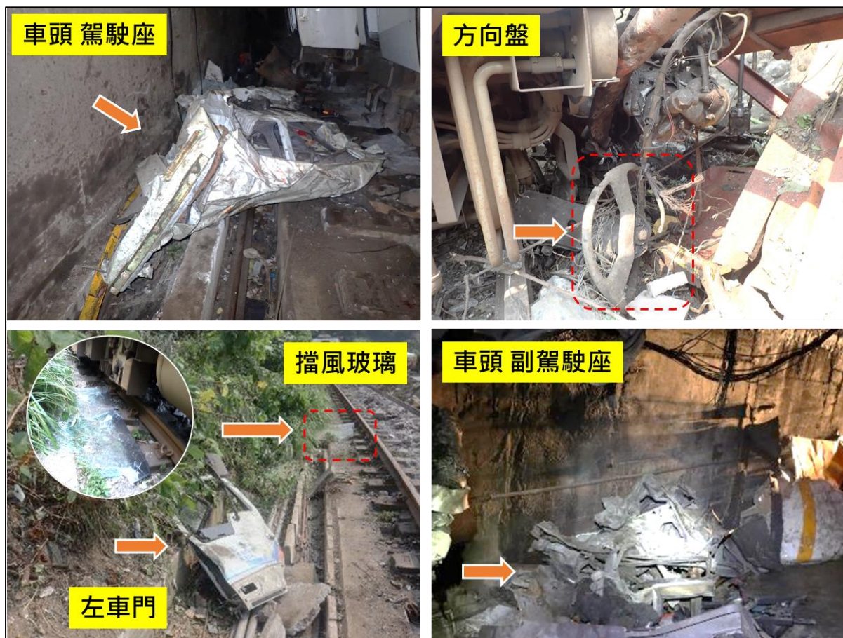
圖 1.3-12 大貨車車頭受損情形
