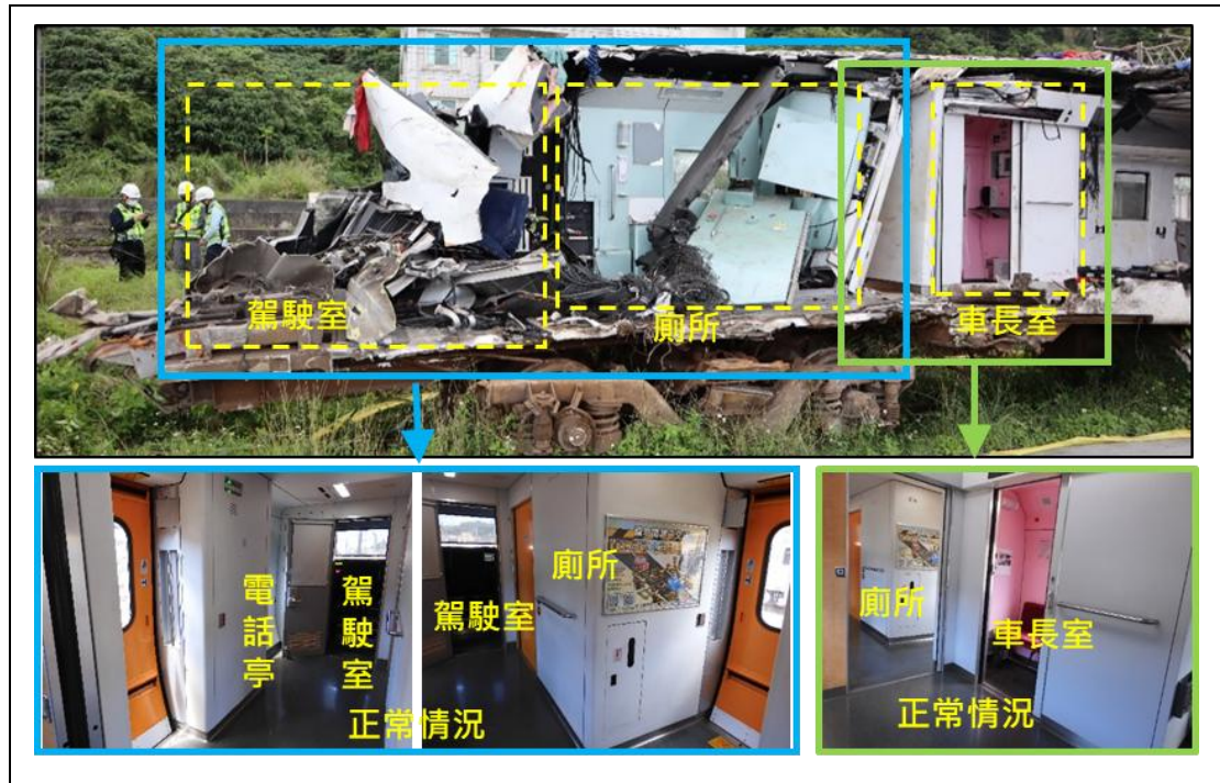
圖 1.13-22 第 8 車前段受損情形
