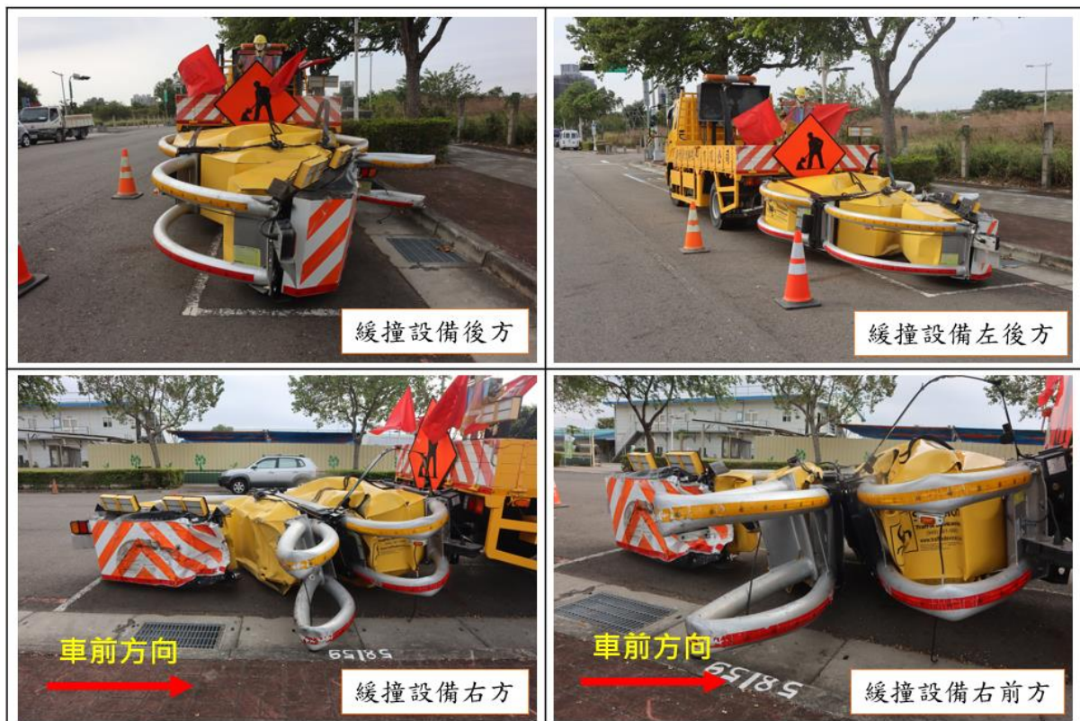
圖 1.4-3 緩撞設施損害情形
