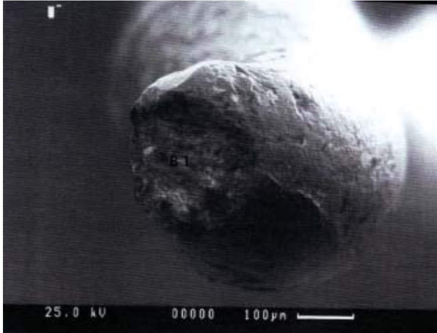
圖十二、#1電線B端斷裂面的SEM相片。斷裂面為圓形，頸縮明顯。
