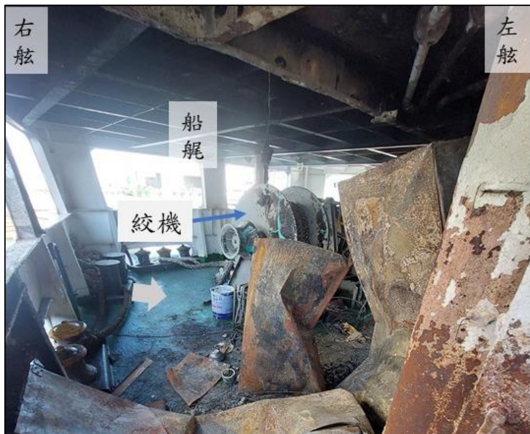
圖 1.4-12 後甲板損害情況
