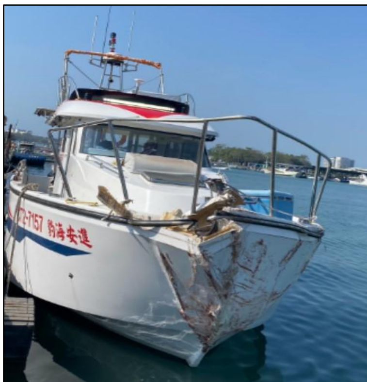
圖 1.3-1 「進」船船首受損之外觀圖
