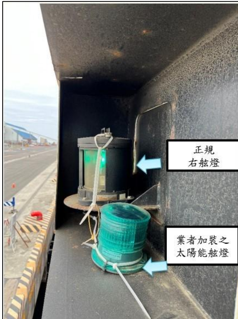
圖 1.7-10 運輸駁船正規右舷燈及加裝之太陽能舷燈照片（事故後）
