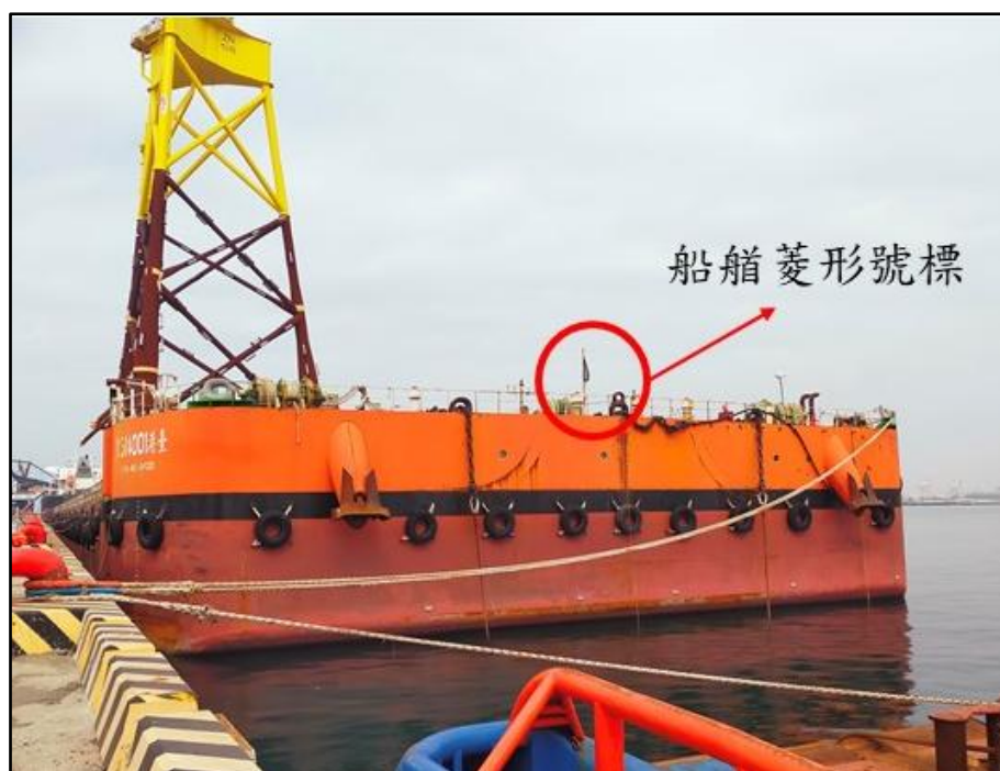
圖 1.7-4 運輸駁船菱形號標外觀圖
