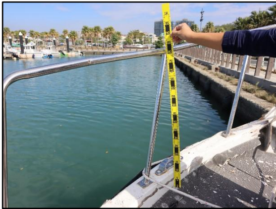
圖 1.14-5 「進」船船首護欄高度約 84 公分
