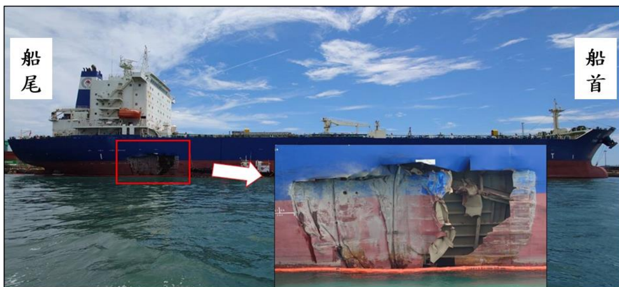
圖 1.3-2 「通運」受損照片
