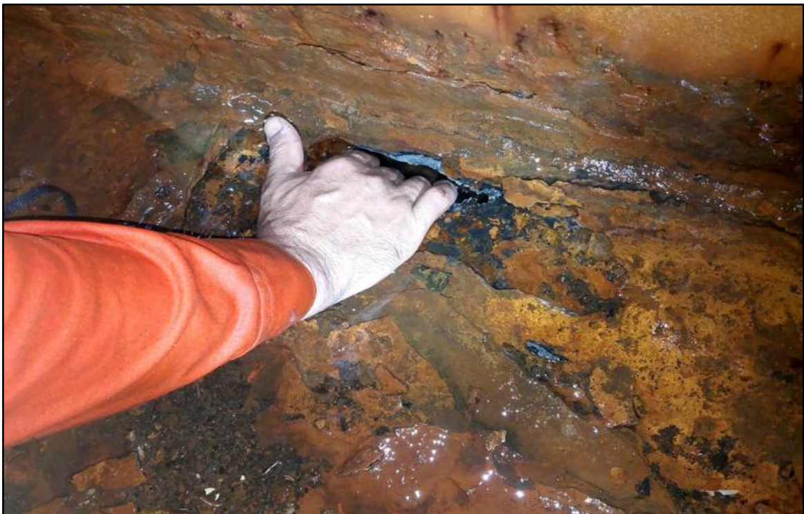
圖 2.2-1 天使輪第 3 貨艙內的貨艙底板破裂外觀圖
