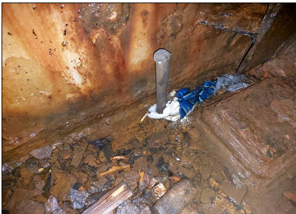
圖 2.2-2 天使輪船員使用木塞暫時性封閉貨艙底部的測深管破洞
