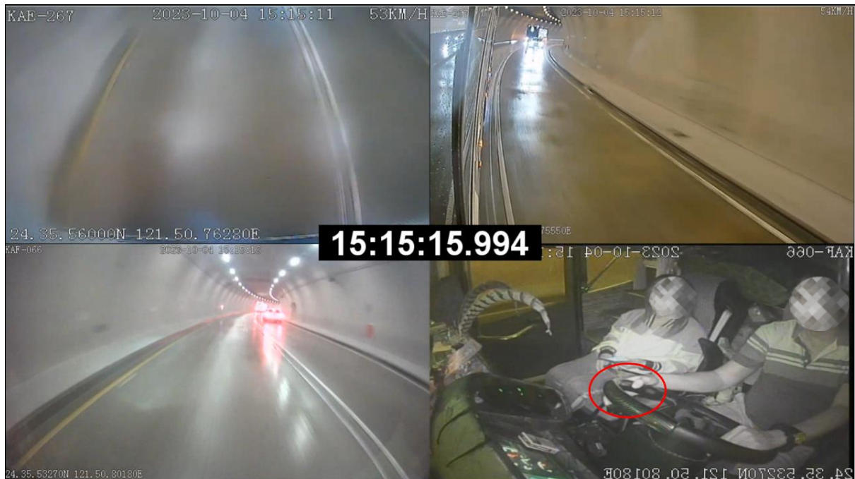
約 1515:16.0 時事故駕駛員撥下油壓減速器撥桿
