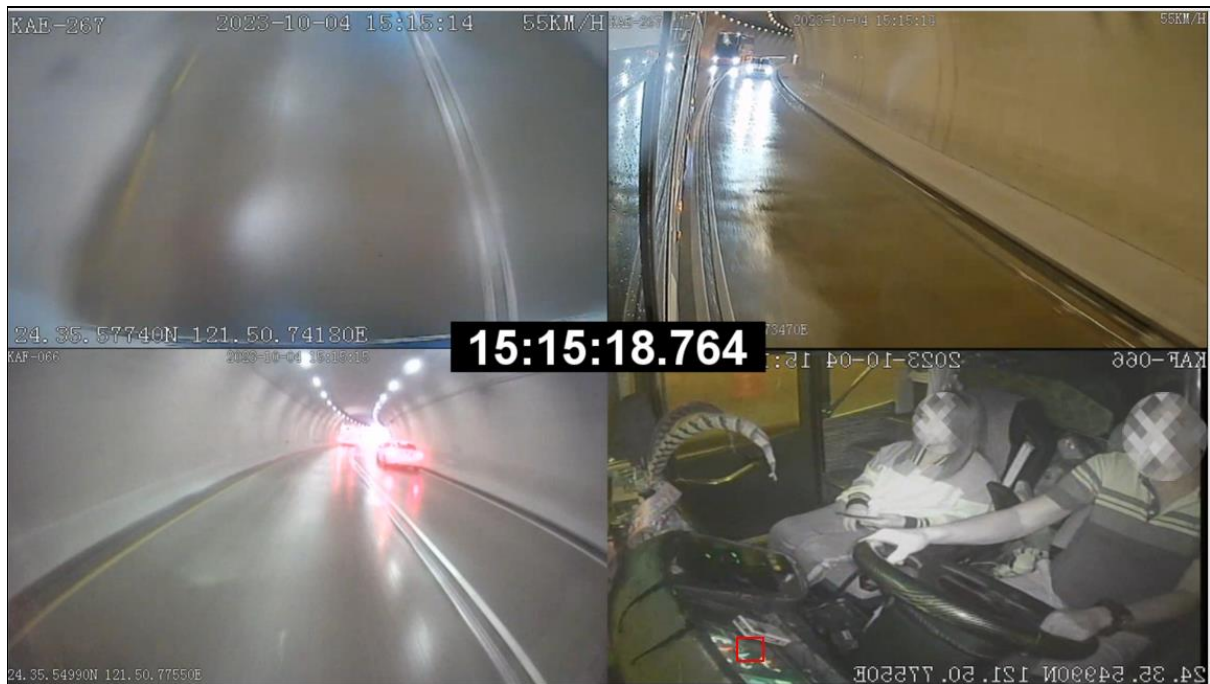
15:15:18.8 時事故車輛油壓減速器作動指示燈熄滅
