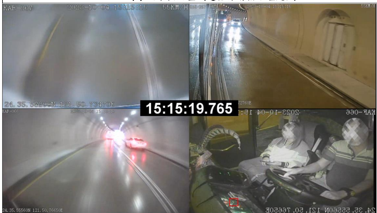
15:15:19.8 時事故車輛油壓減速器作動指示燈亮綠燈
