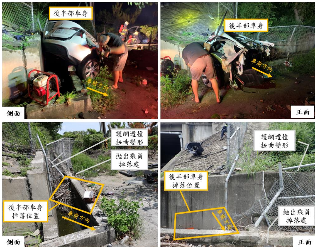
圖 1.4-5 後半部車身、拋出乘員掉落位置及遭撞損護網
