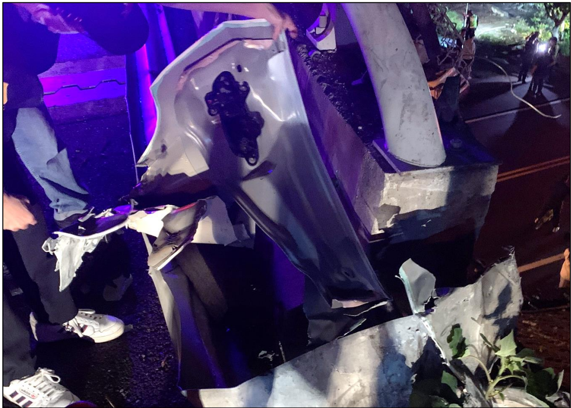
圖 1.3-3 遺留於高速公路之左後車門
