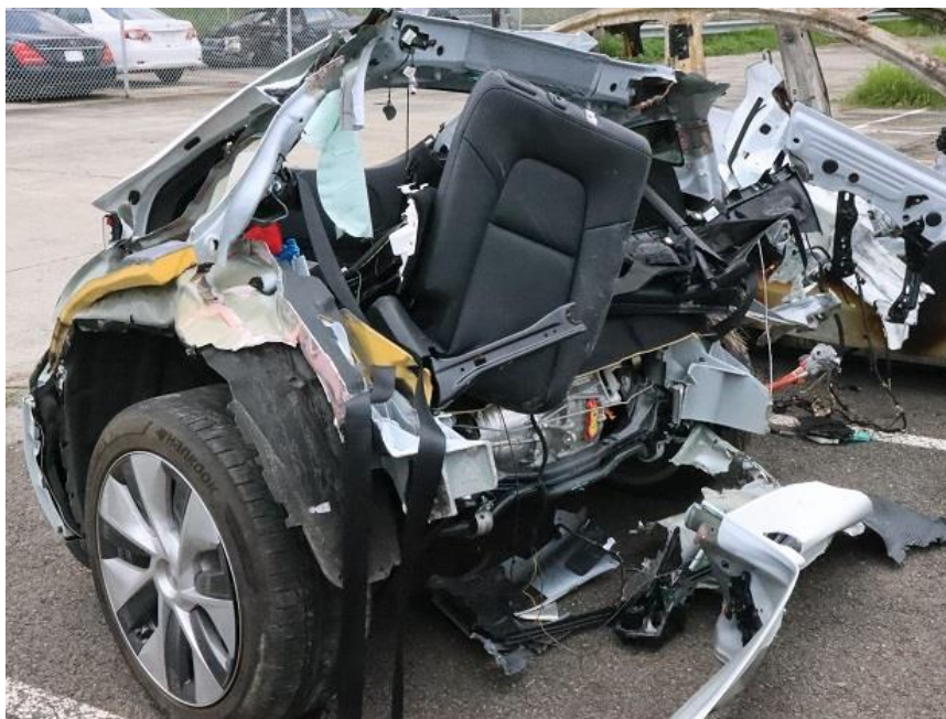
圖 1.12-1 右後座安全帶斷裂（上方段捲收部分已拉出）
