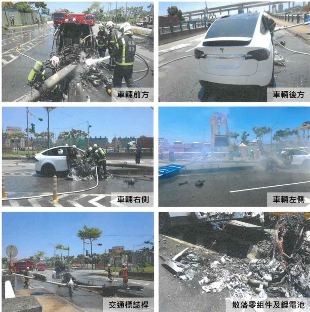
圖 1.15-8 事故車輛及標誌桿損害情形
