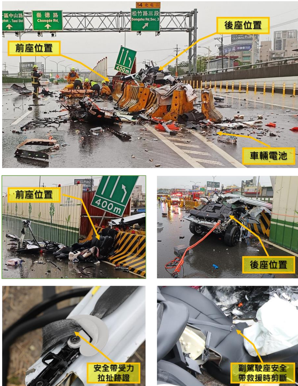
圖 1.15-10 電動車 B 及標誌桿損害情形
