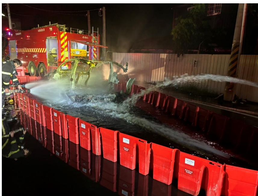
圖 1.12-3 事故車輛高壓電池模組於圍欄內降溫情形
