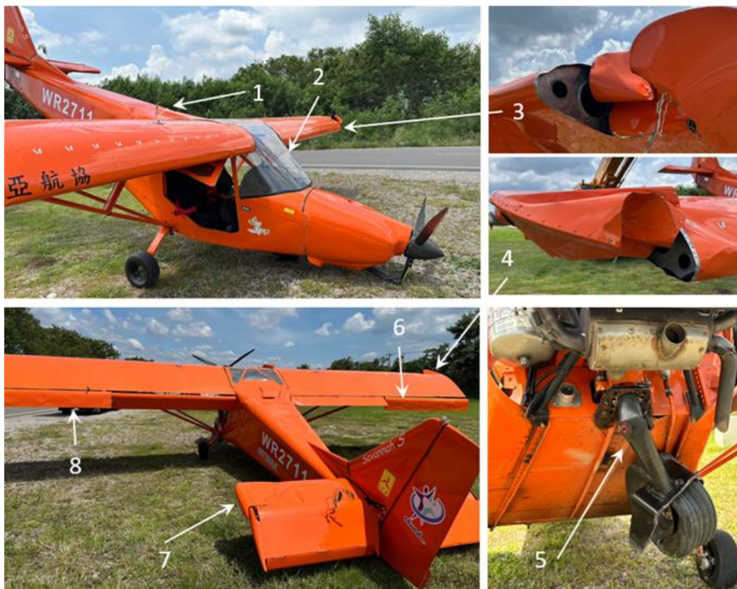
圖 1.8-3 事故載具體損傷情形對應位置圖
