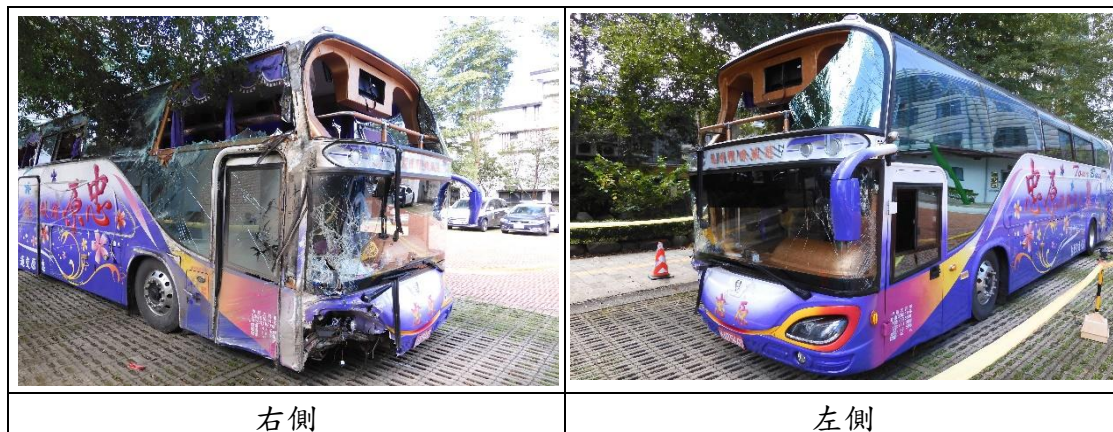
圖 1.3-3 事故車輛擋風玻璃受損情形
