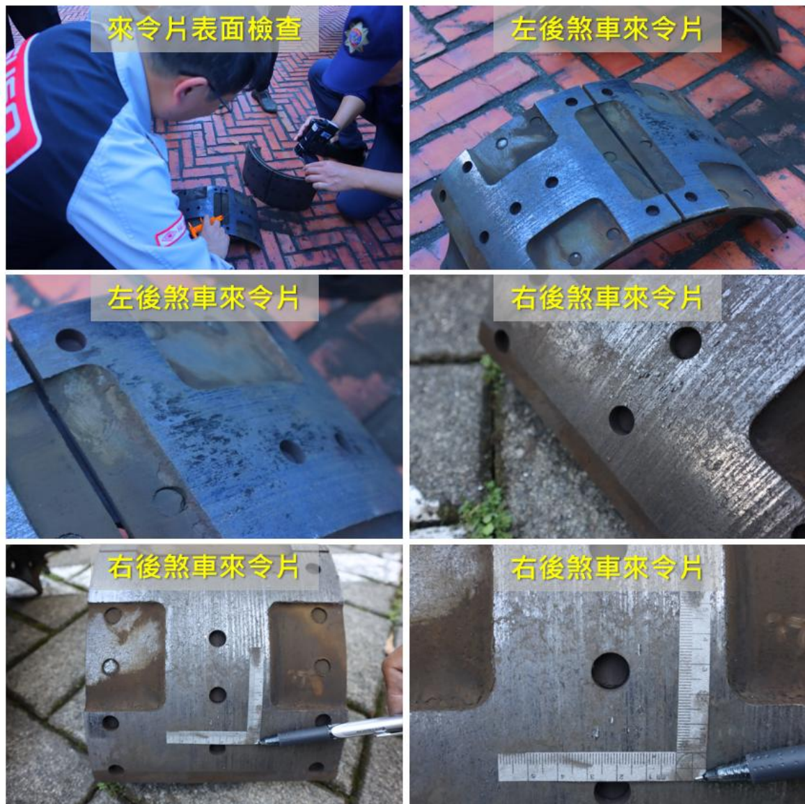
圖 2 後輪煞車來令片表面檢測情形
