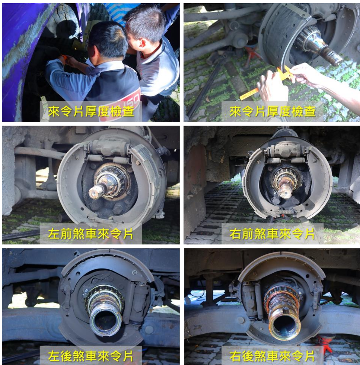
圖 1 煞車來令片檢測情形
