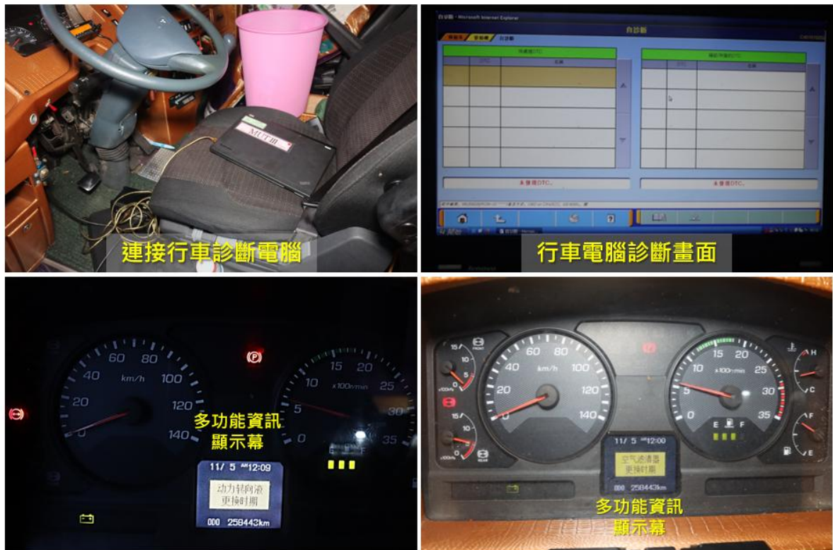
圖 3 行車電腦檢測情形
