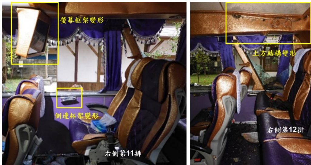
圖 1.3-6 事故車輛右側第 11、12 排損壞情形
