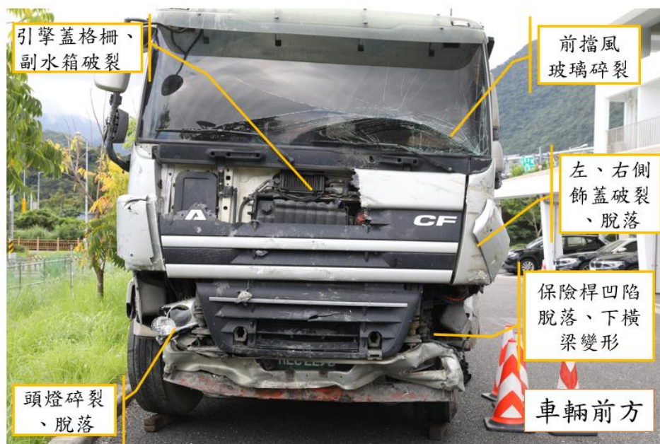
圖 1.3-5 事故曳引車損害情形（車輛前方）
