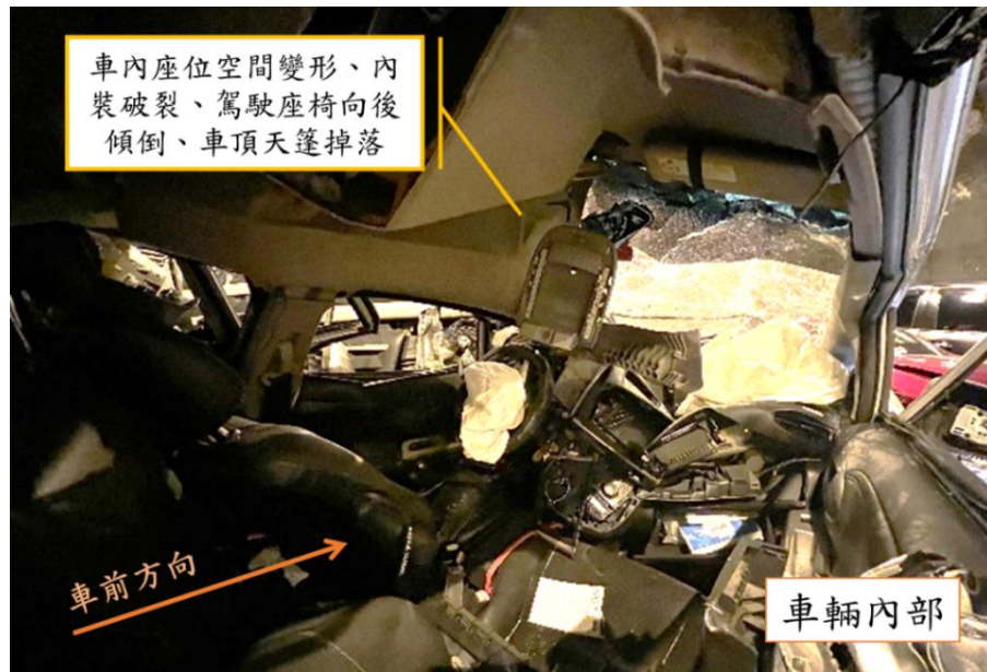
圖 1.4-5 B 車損害情形（車輛內部）
