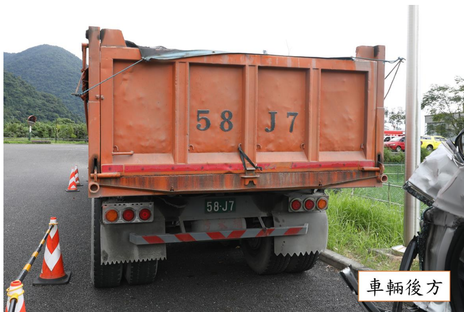
圖 1.3-6 事故半拖車損害情形（車輛後方）
