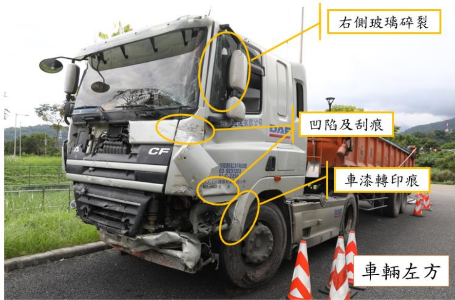
圖 1.3-3 事故曳引車損害情形（車輛左方）
