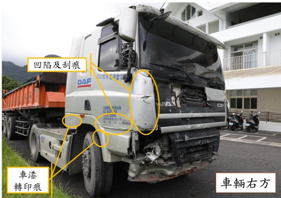
圖 1.3-4 事故曳引車損害情形（車輛右方）
