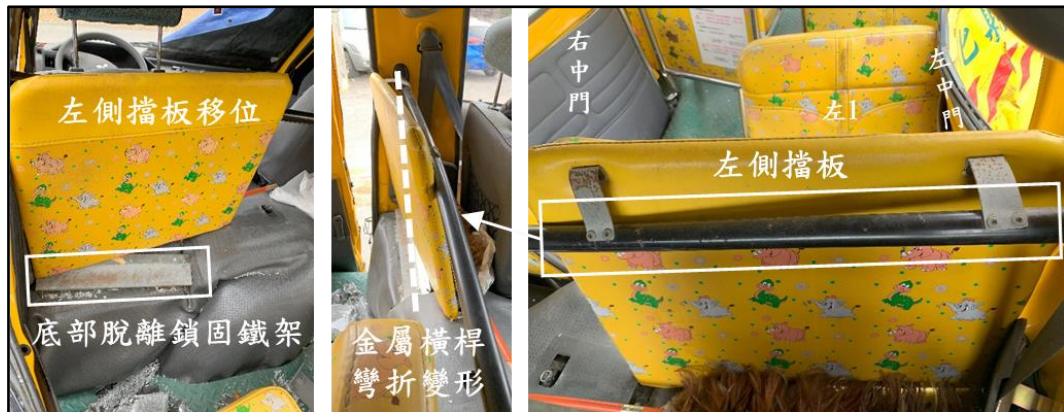
圖 1.3-5 左側擋板受損情形
