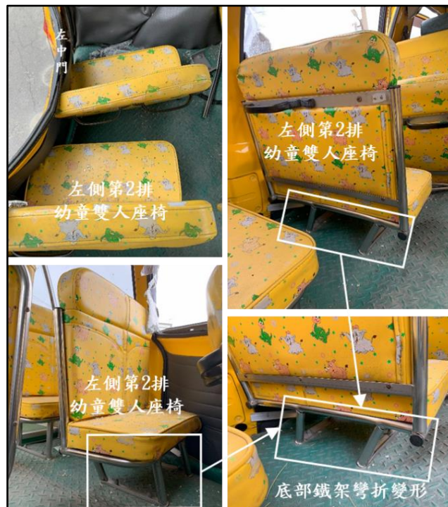
圖 1.3-8 左側第 2 排幼童雙人座椅受損情形
