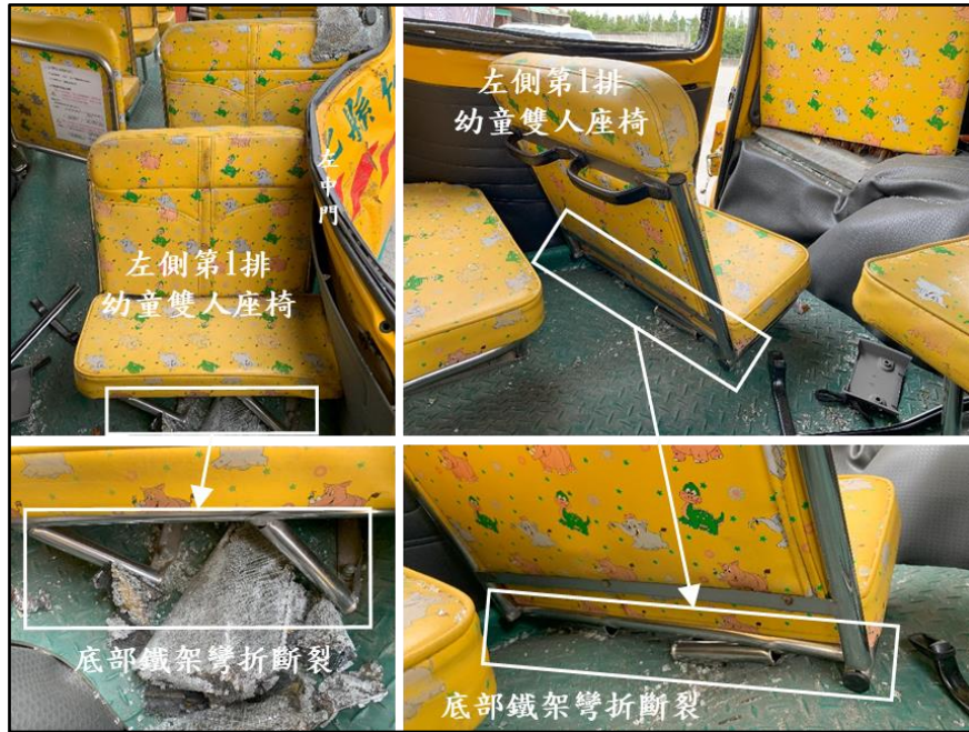
圖 1.3-7 左側第 1 排幼童雙人座椅受損情形
