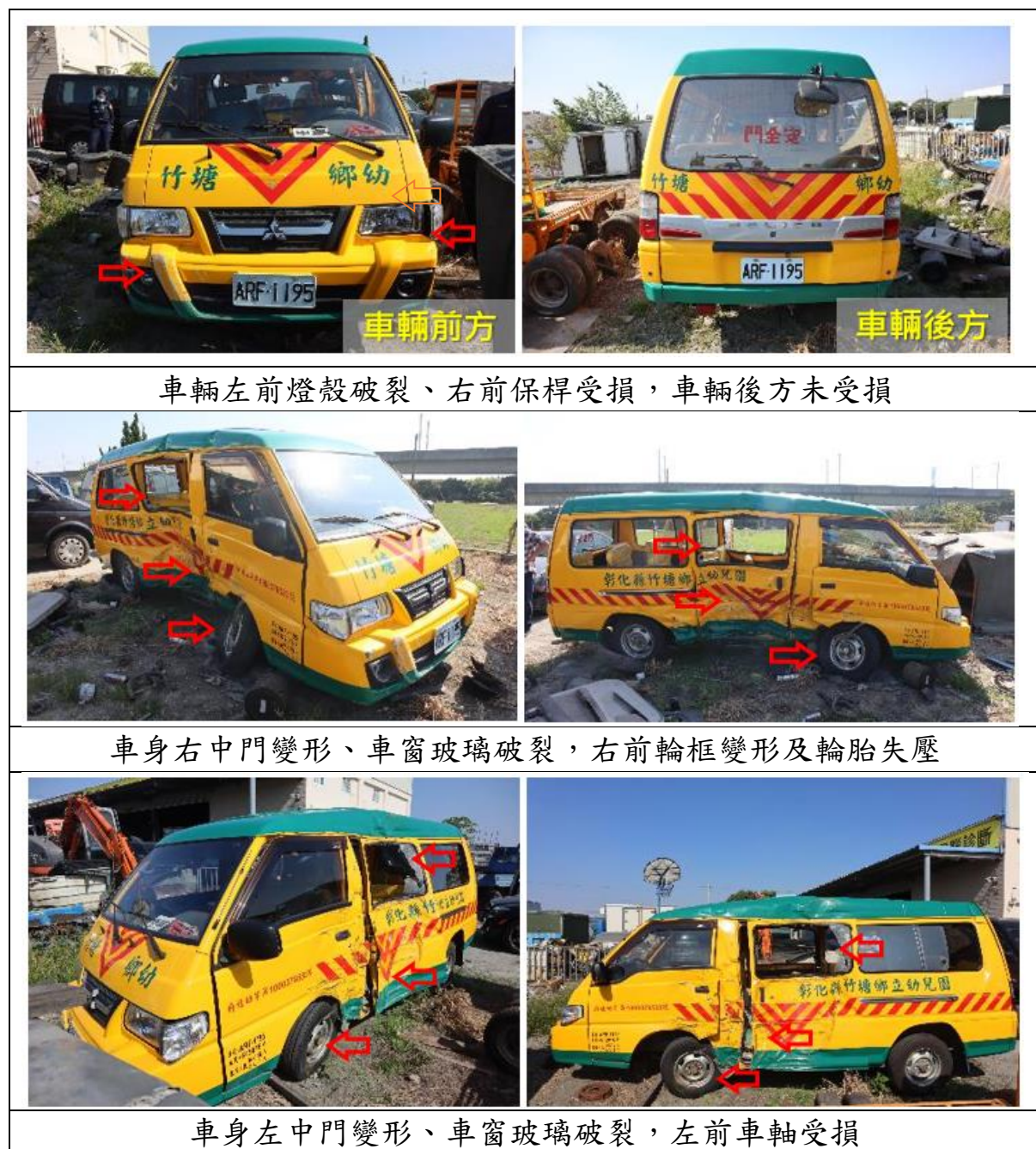
圖 1.3-9 事故 A 車外部損害情形
