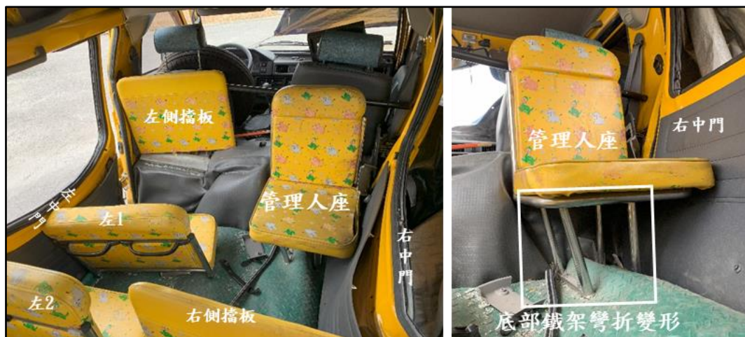
圖 1.3-6 管理人座椅受損情形
