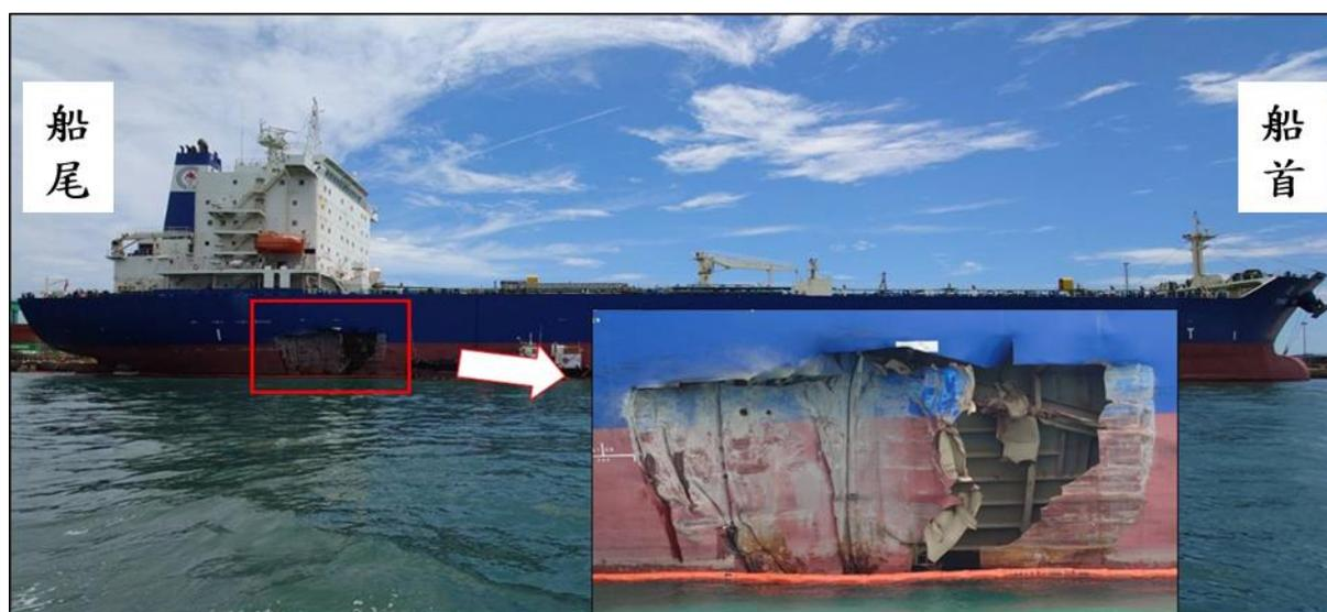
圖 1.3-2 「通運」受損照片
