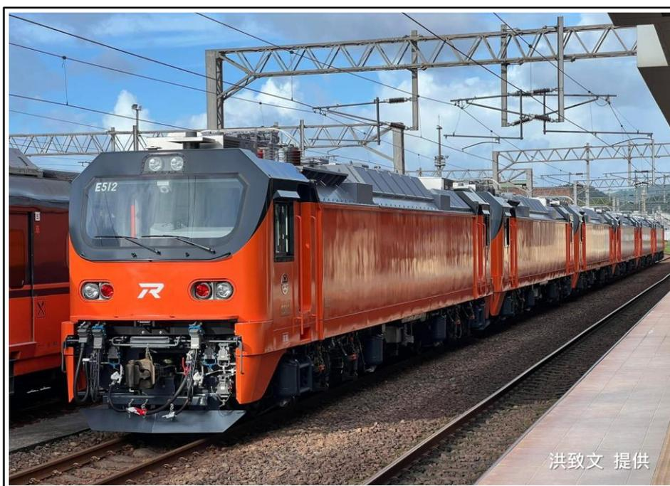
圖 1.5-1 臺鐵公司 E500 型電力機車
