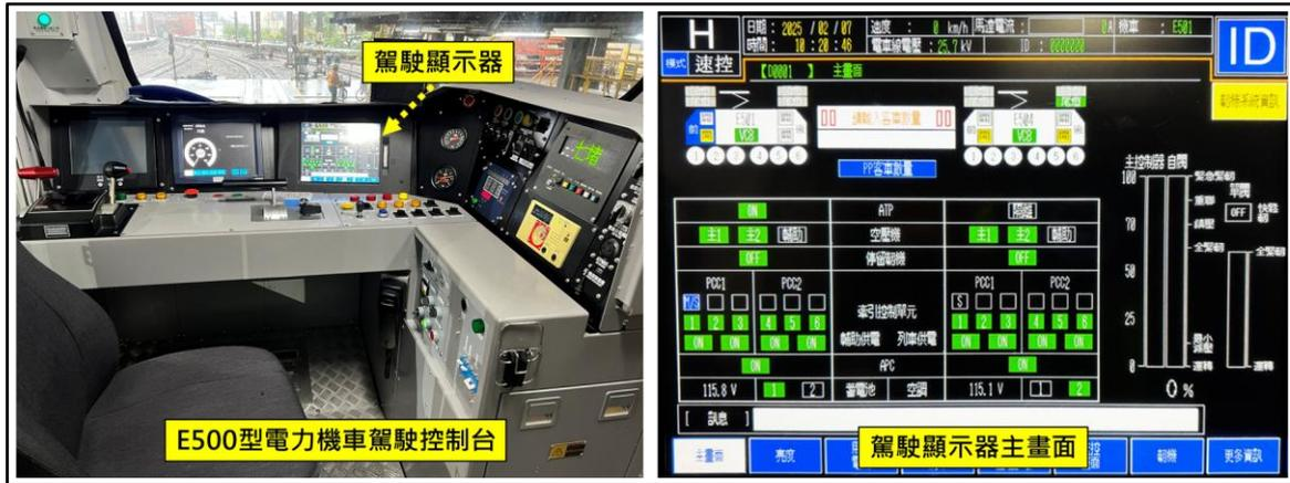
圖 1.9-2 E500 型電力機車駕駛控制台及駕駛顯示器
