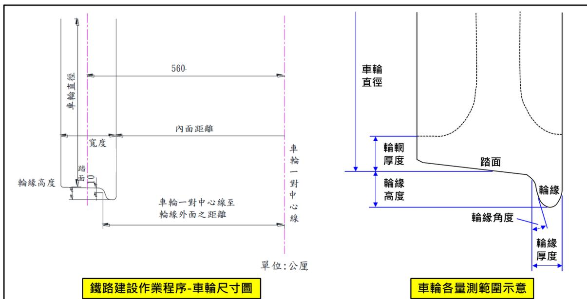
圖 1.5-2 車輪量測位置示意
