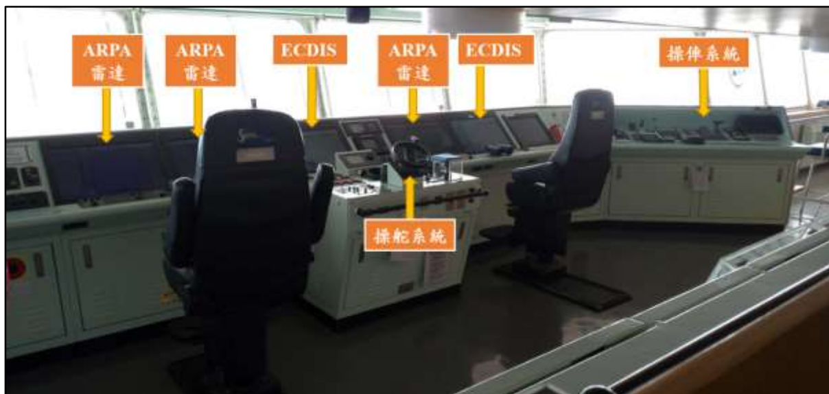
圖 1.4-2 駕駛臺內部航海儀器配置圖
