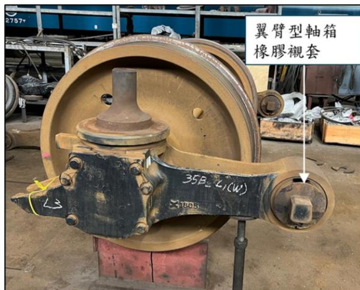
圖 1.11-5 翼臂型軸箱橡膠襯套
