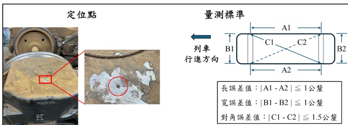
圖 1.11-1 轉向架尺寸量測定位點及標準
