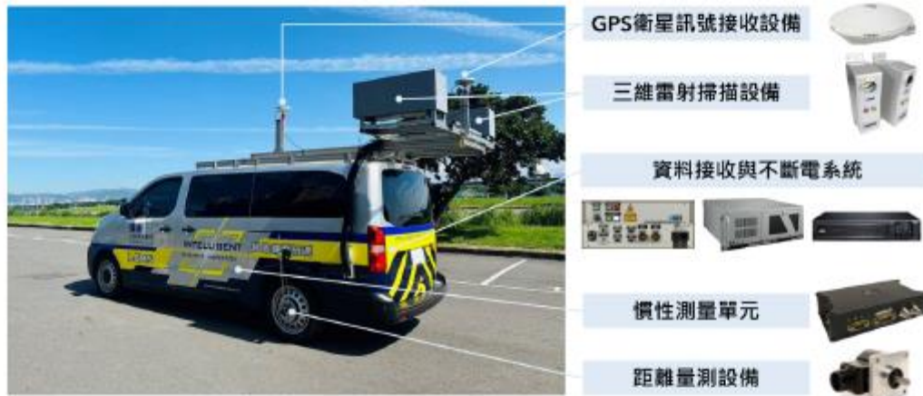
圖 2.1-1 LCMS 鋪面雷射檢測系統
