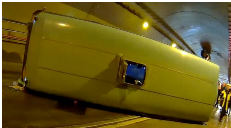
圖 1.12-4 事故車輛車頂緊急出口
