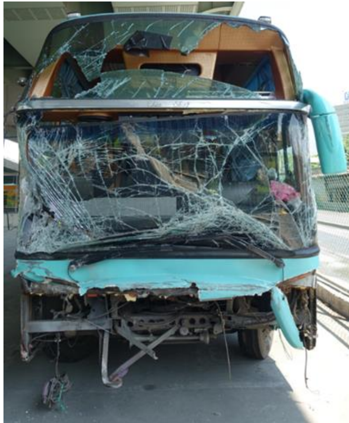
圖 1.12-1 事故車輛擋風玻璃受損情形
