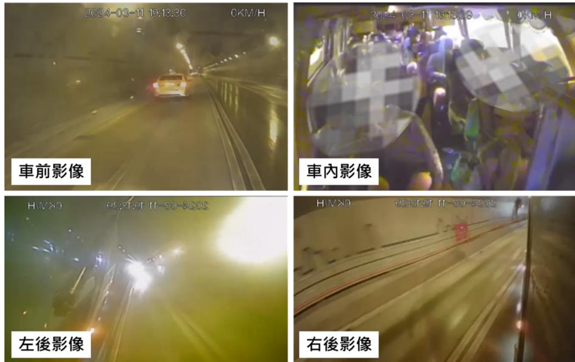
圖 1.9-2 事故車輛行車視野輔助系統畫面
