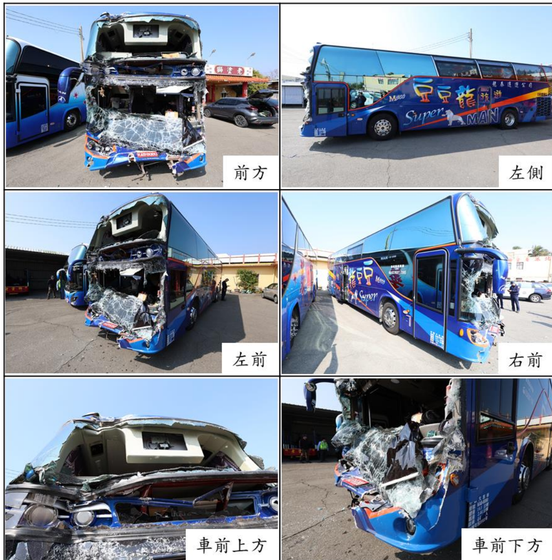
圖 1.3-2 事故車輛外部損害情況
