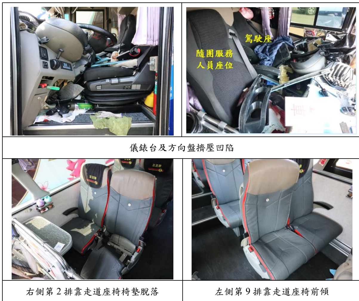
圖 1.3-3 事故車輛座椅損害情形
