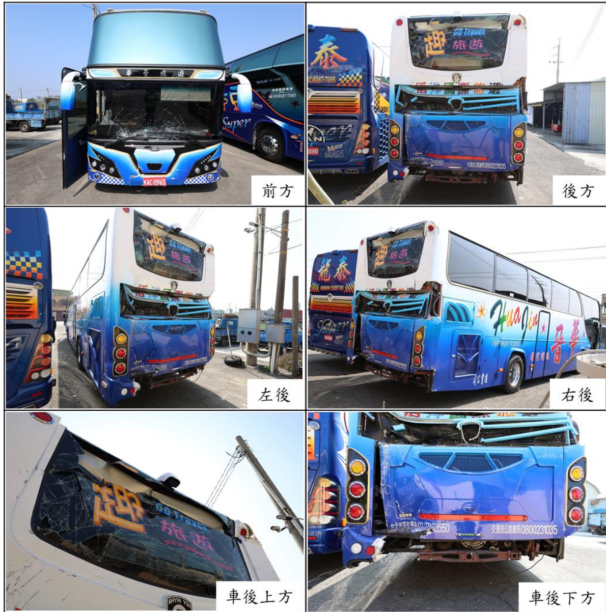
圖 1.4-1 前方遊覽車受損情形
