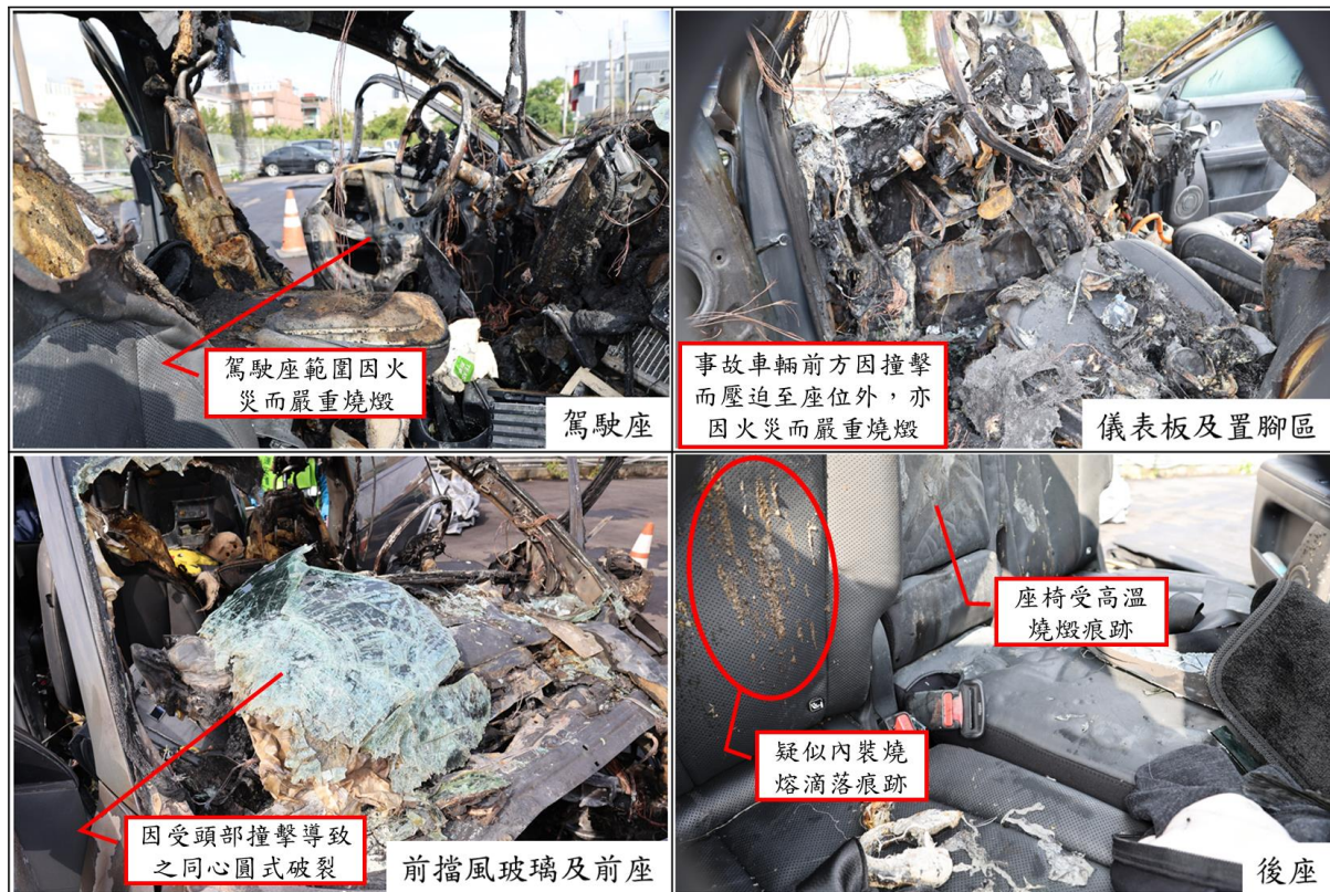
圖 1.3-2 內部損害狀況
