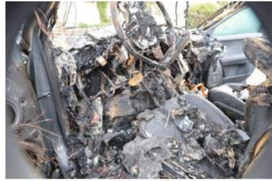
左前座損害情形
