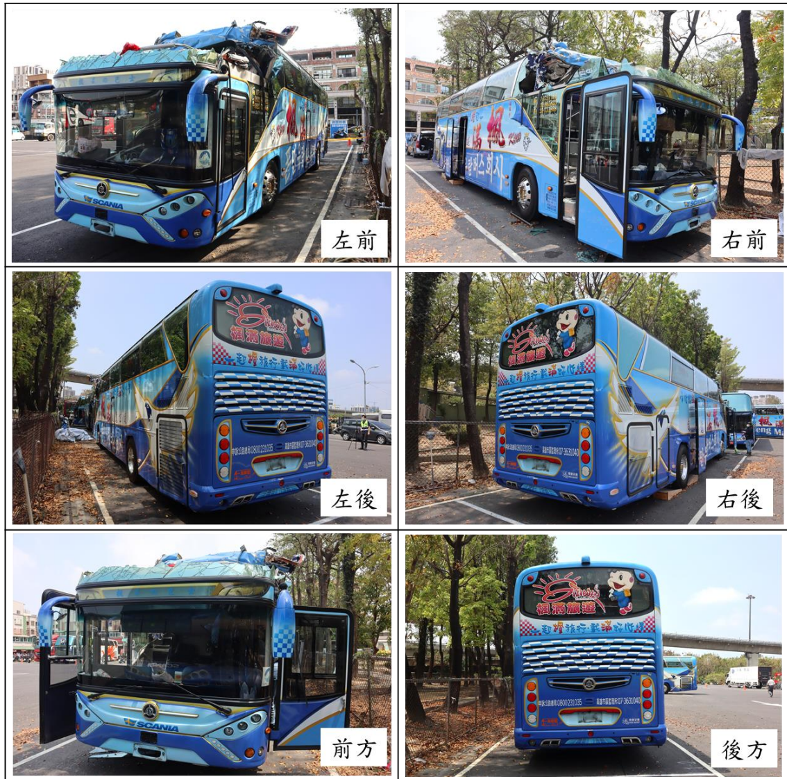
圖 1.3-2 事故車輛外部損害狀況
