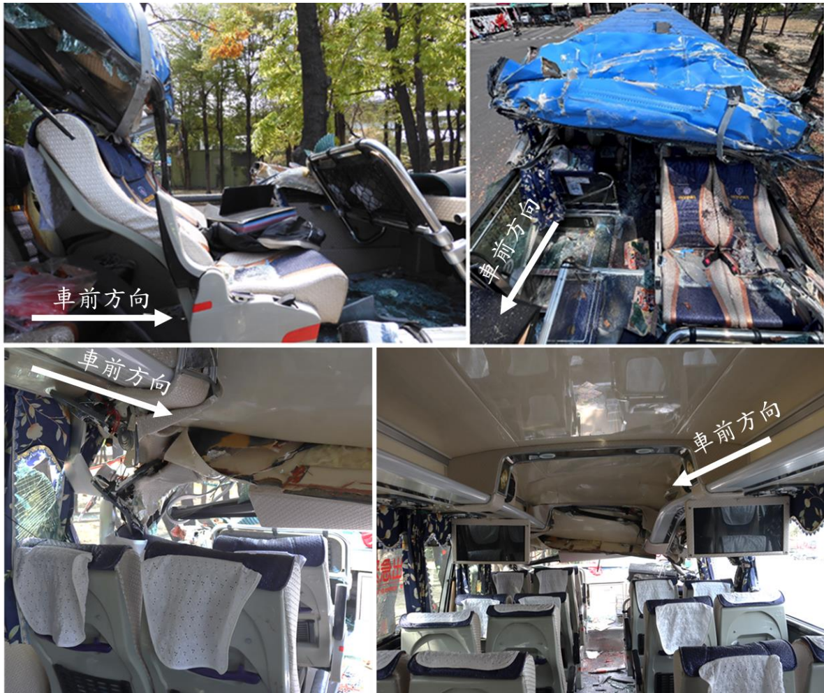
圖 1.3-3 事故車輛內部損壞狀況
