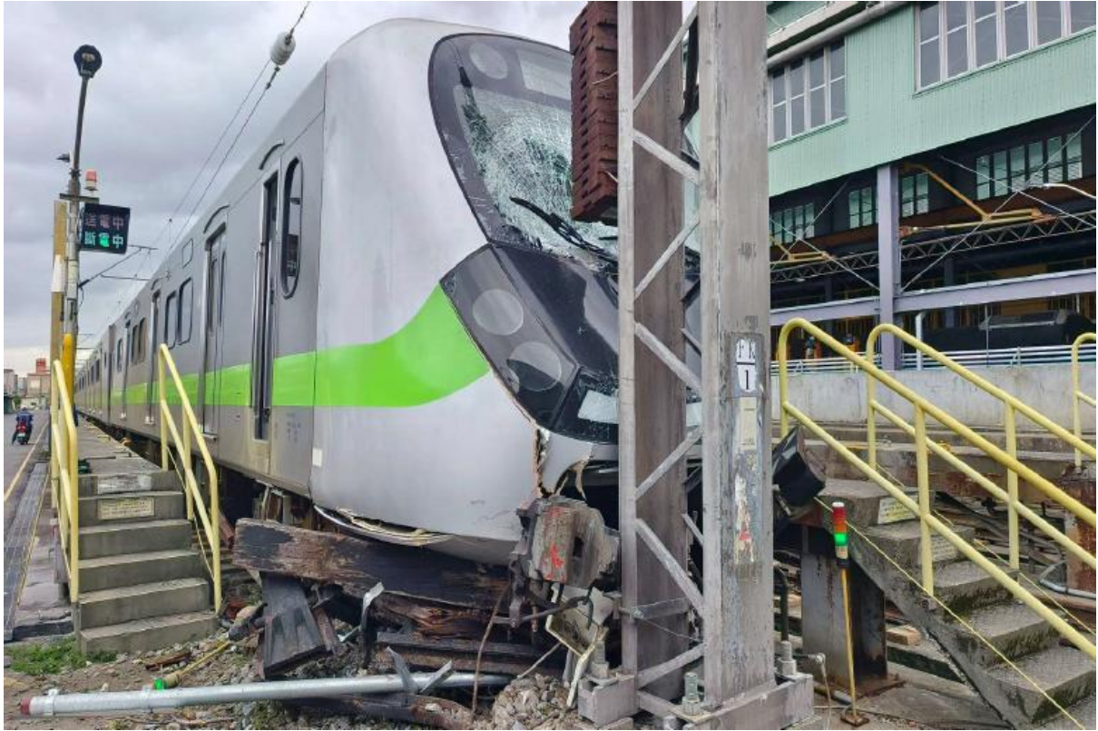
圖 1.10-3 EMU900 列車車頭撞及止衝檔導致前端 2 軸出軌
