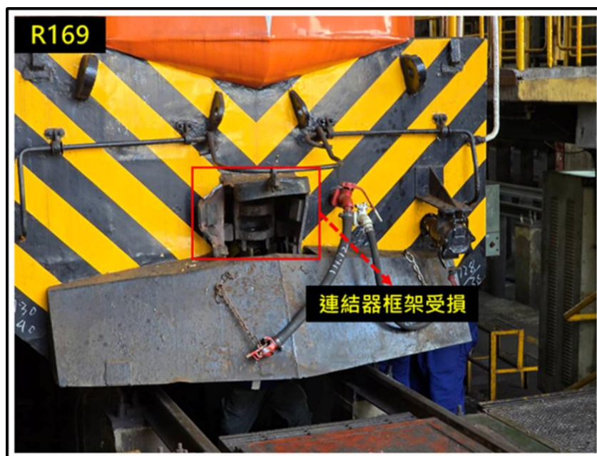
圖 1.2-2 調車機損壞情形
