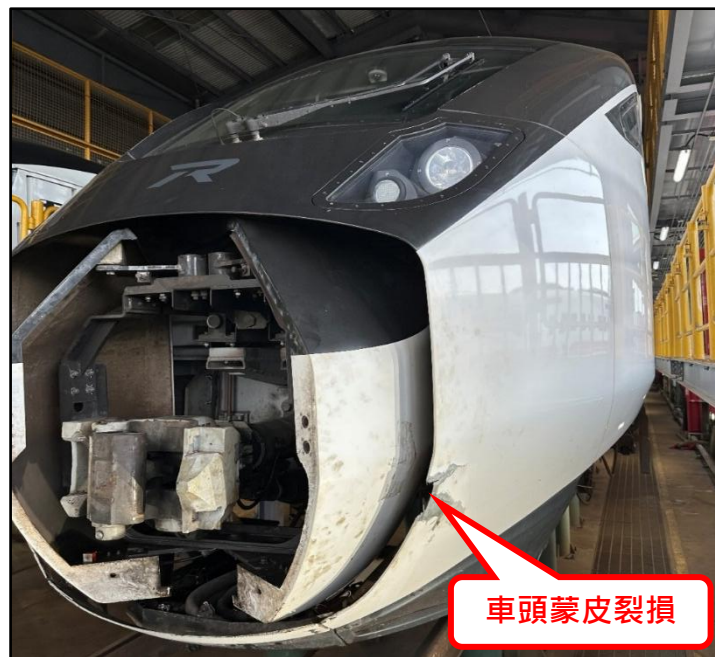
圖 1.2-4 車頭蒙皮裂損
