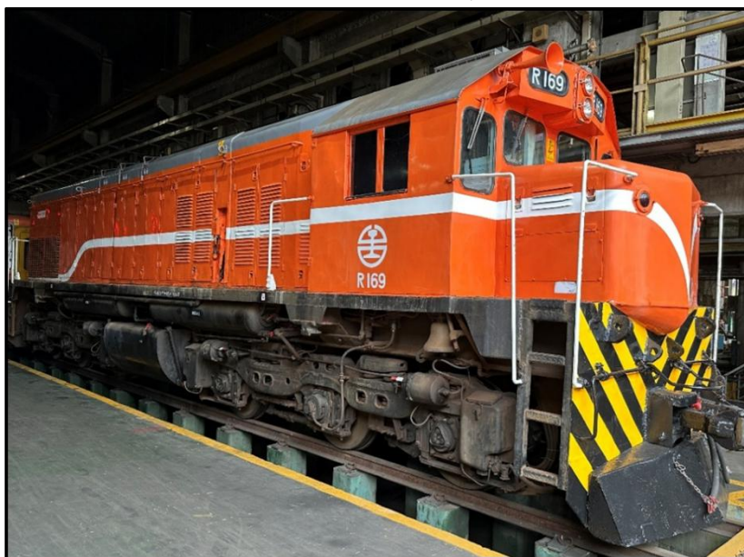
圖 1.2-1 調車機-R150 型柴電機車
