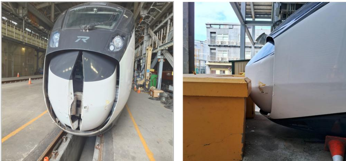
圖 1.10-2 EMU3410 列車編組撞及止衝檔導致車頭鼻頭蓋受損
