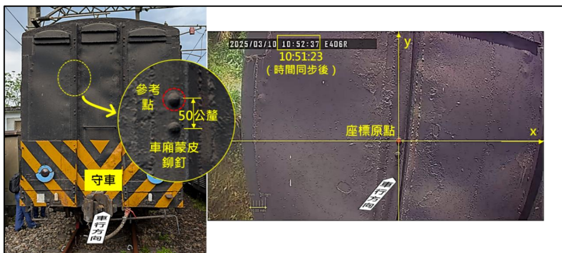
圖 1.10-5 軟體參考點及位移校正基準示意
