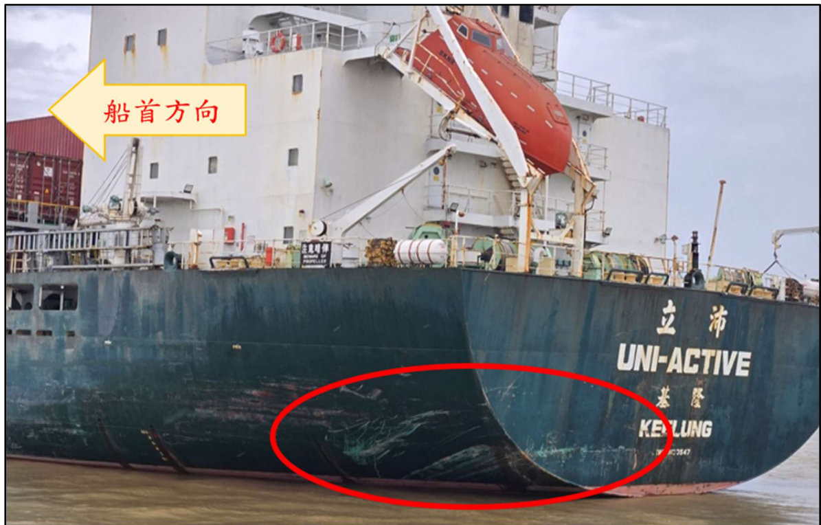
圖 1.3-1 立沛輪損害外觀照片 11
