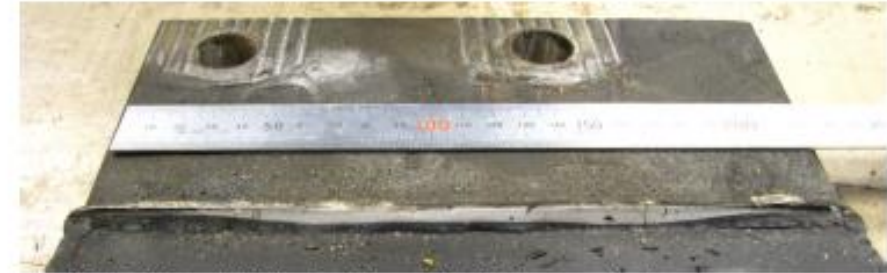
Figur 4. Svets 1 i ankomstsblok, ljusgrå del av sprickytan bedöms som restbrott.
