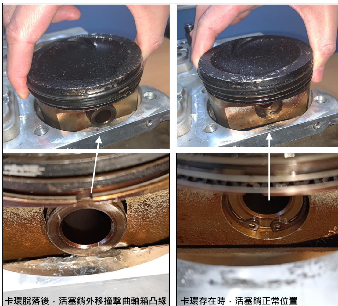
圖 2.2-2 模擬活塞銷與曲軸箱凸緣接觸情況
