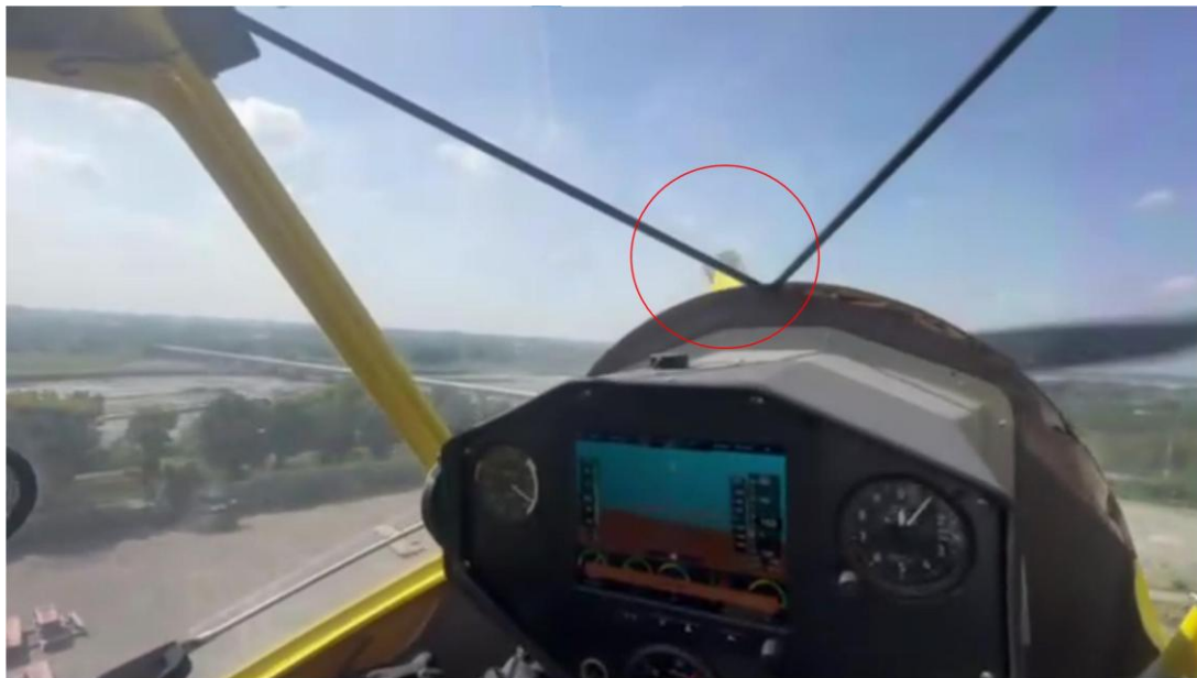
圖 1.10-5 引擎零件擊穿引擎罩截圖
