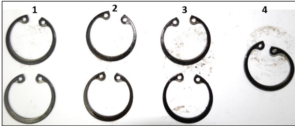
圖 1.9-9 各缸活塞組件中之外張式 C 型卡環
