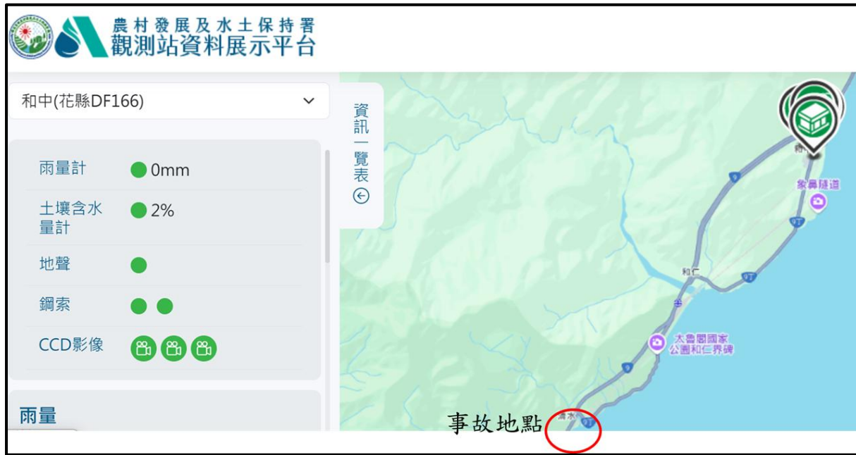
圖 2.1-1 土石流潛勢溪流 DF166 觀測設備示意圖
