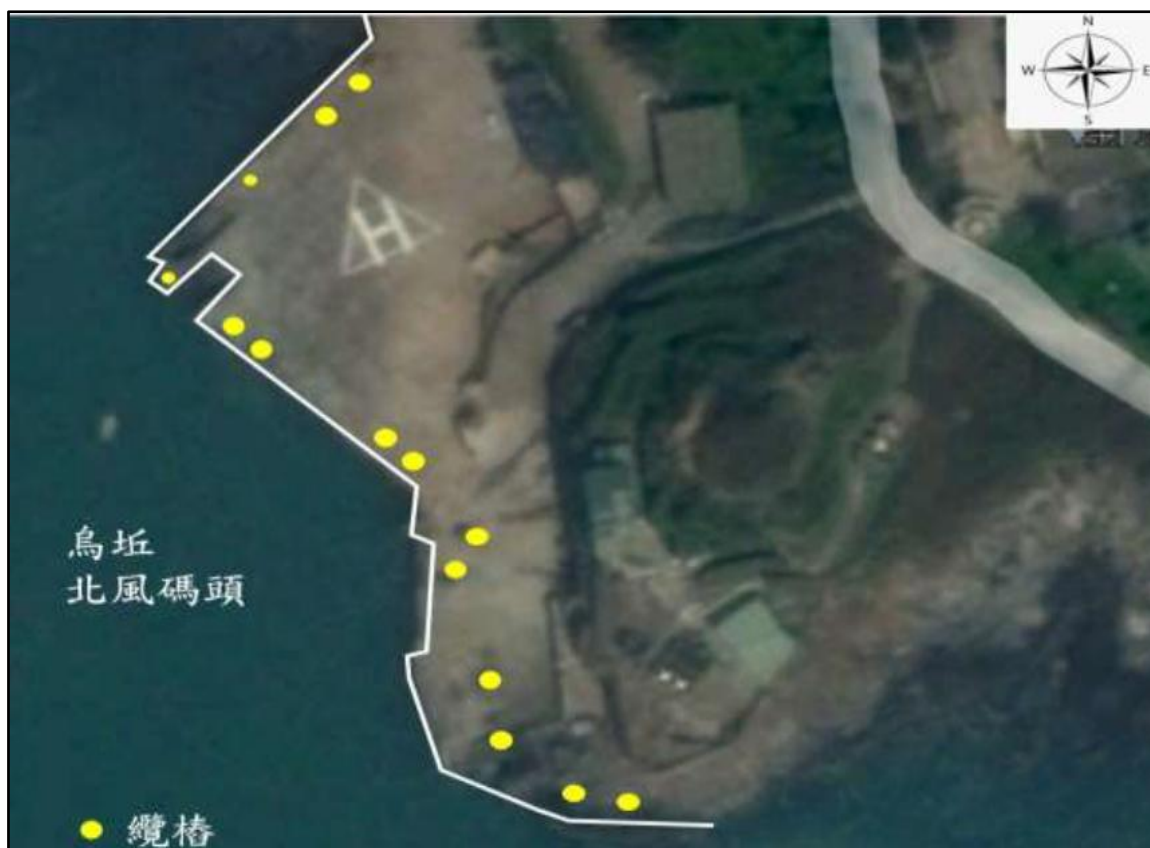
圖 1.6-1 烏坵北風碼頭纜樁位布置示意圖 4
