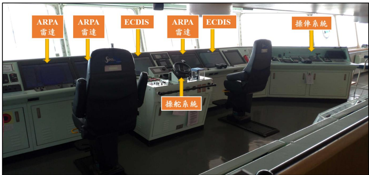
圖 1.4-2 駕駛臺內部航海儀器配置圖
