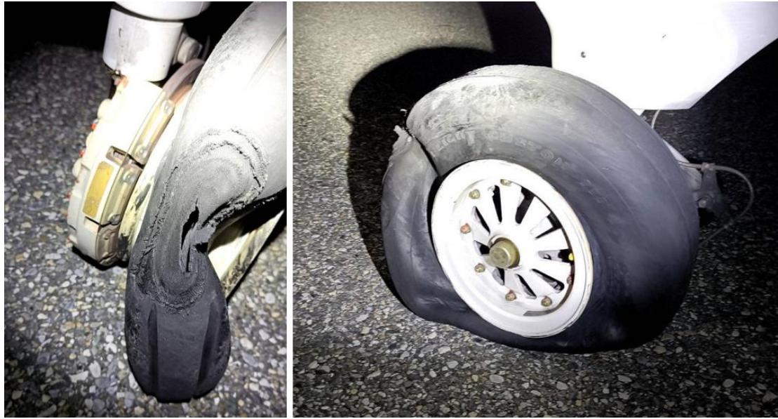
圖 1.12-5 事故航機於跑道停止後輪胎破損情形
