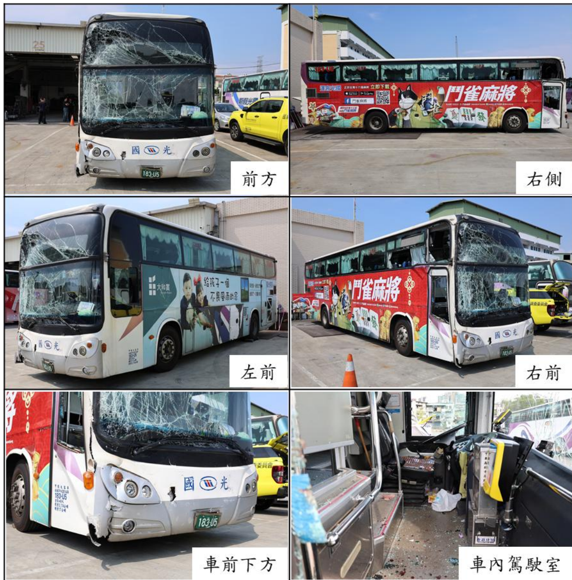
圖 1.3-2 事故車輛外部損害情況
