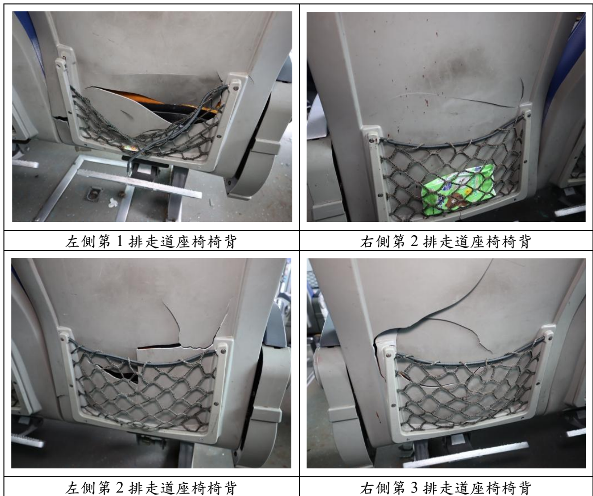
圖 1.3-3 車輛座椅椅背損害情形
