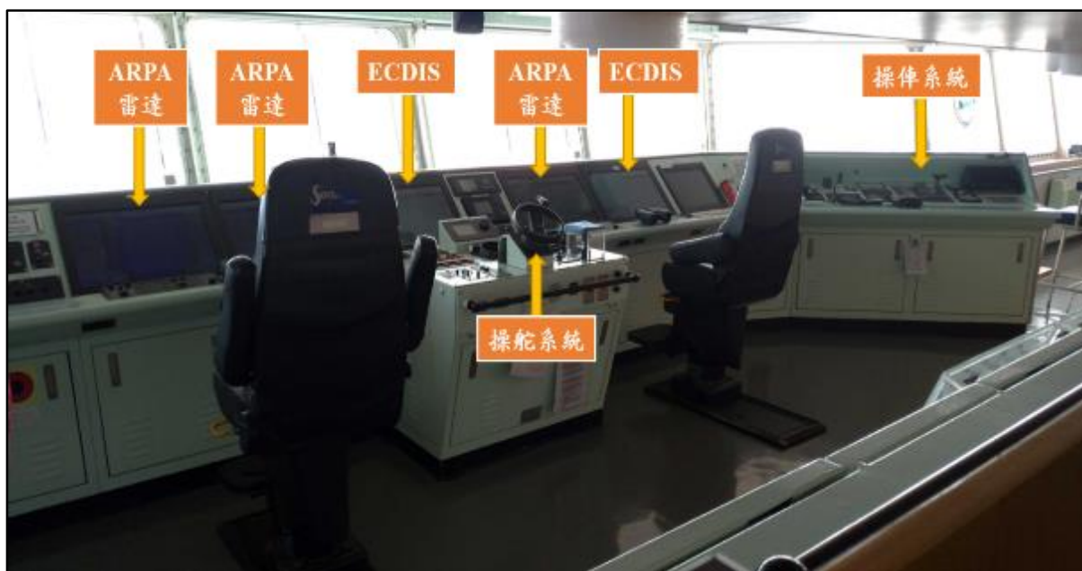
圖 1.2-2 駕駛臺內部航海儀器配置圖
