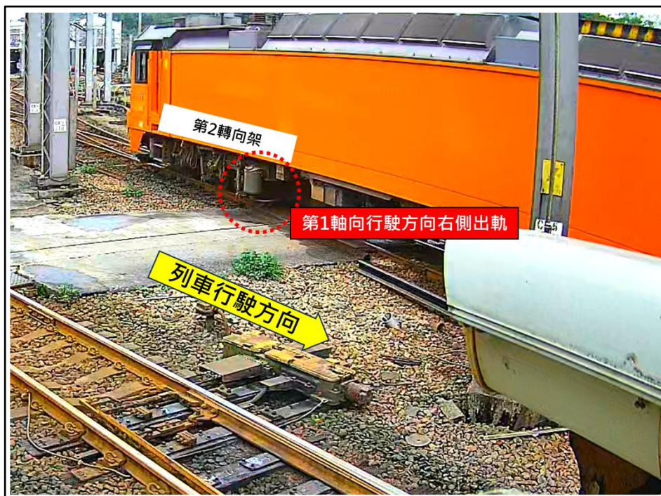
圖 1.1-2 後部 E502 號電力機車第 2 轉向架第 1 軸於 509 號道岔出軌
