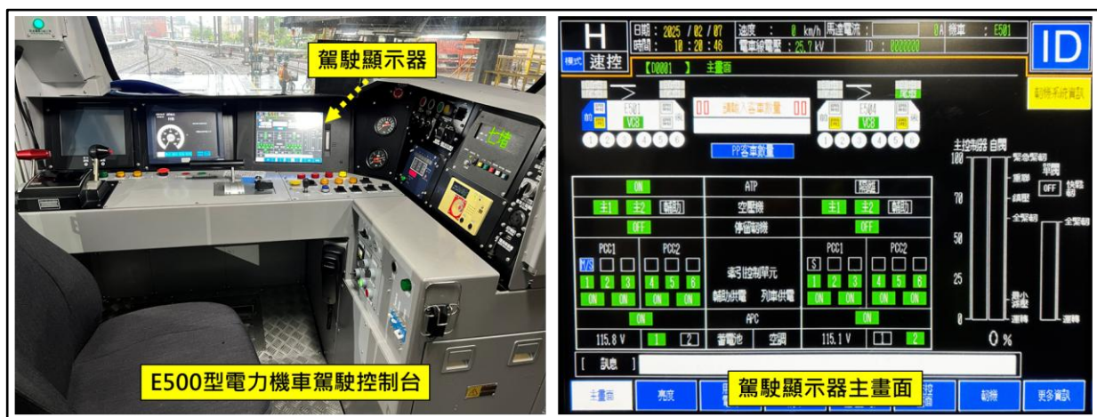
圖 1.9-2 E500 型電力機車駕駛控制台及駕駛顯示器
