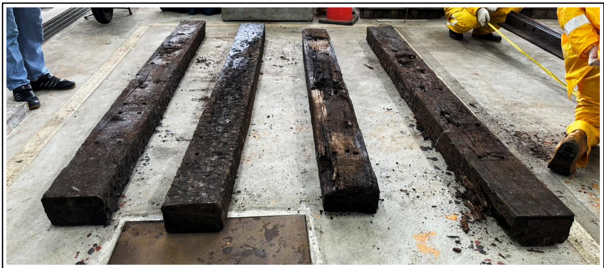
圖 1.10-8 第 509 號道岔枕木表面裂痕、破損及壓陷
