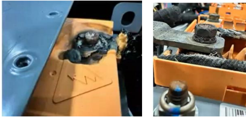
圖 1.15-1 EAL-0696 車輛 L 電池包發現電極導片上方保護蓋融化
