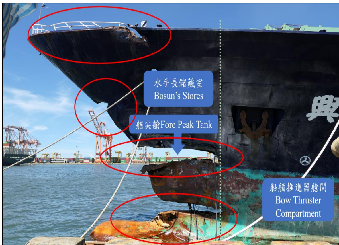
圖 3 船艏受損情形（調查小組現場勘查）
