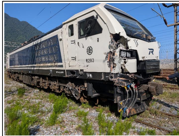
圖6 R203 號柴電機車車頭損壞
