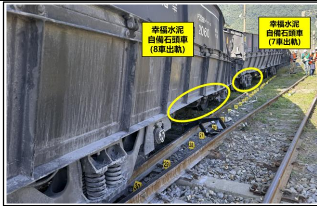
圖 2 幸福水泥公司貨物列車 2 節車廂出軌
