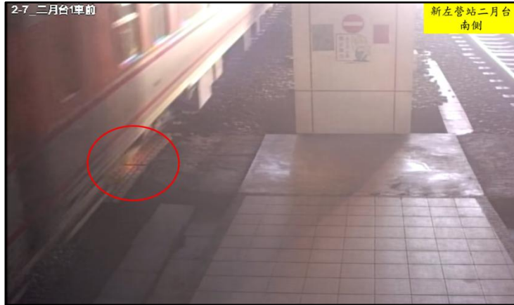
圖 3 事故列車抵達新左營站時車底可見明火
